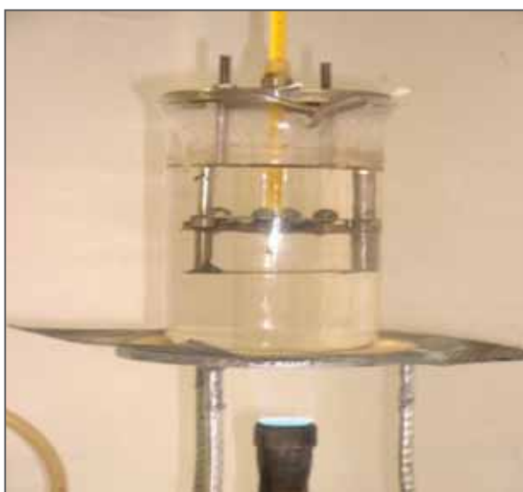
Figura 26 – Vista do conjunto em aquecimento.
