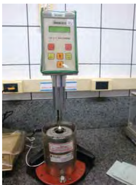
Figura 32 – Vista do viscosímetro brookfield modelo RV.
