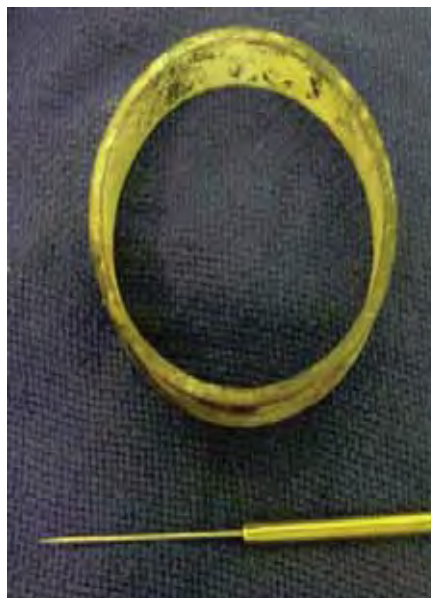
Figura 23 – Recipiente qual amostra será ensaiada e agulha de penetração.
