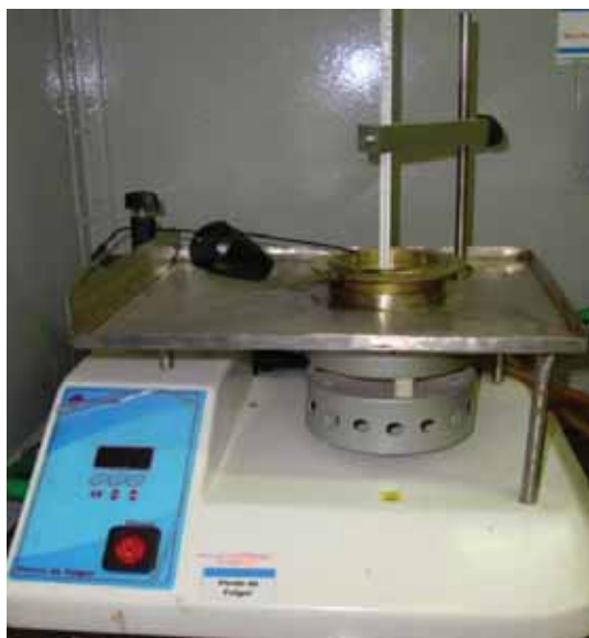
Figura 30 – Vista parcial do equipamento automático para realização ensaio de ponto de fulgor.
