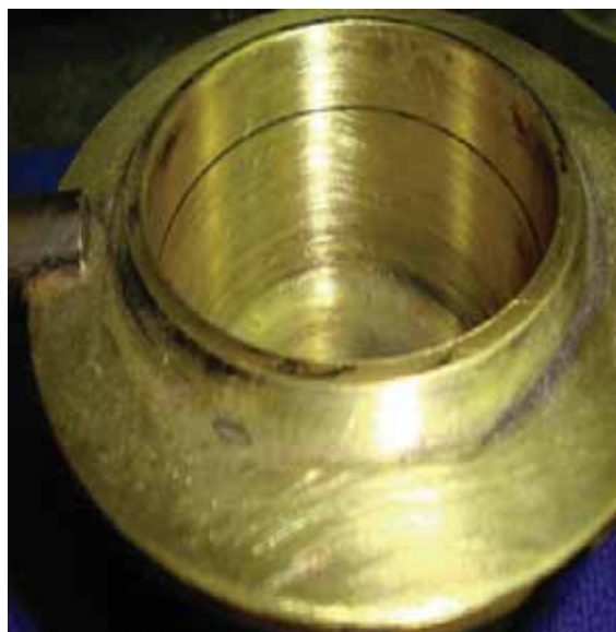
Figura 31 – Vista da cuba para realização ensaio de ponto de fulgor.
