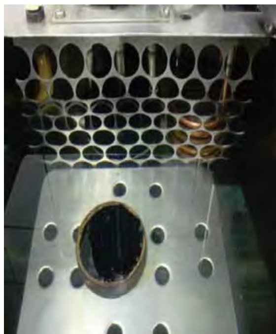
Figura 25 - Amostra condicionada no interior do banho, imersa na água.
