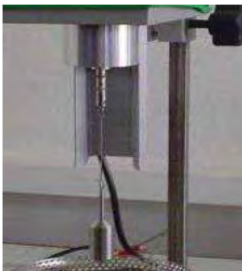
Figura 33 – Modelo de haste e spindle.
