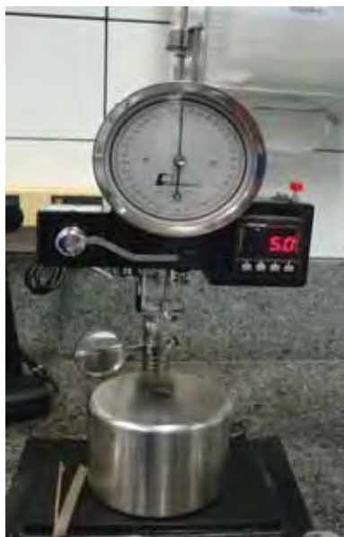
Figura 22 – Vista do penetrômetro completo (haste, agulha, controlador – temporizador).
