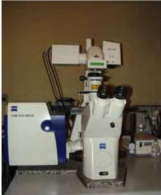
Figura 7 - Microscópio confocal de varredura a laser Zeiss LSM 510 META utilizado para análise do biofilme.
