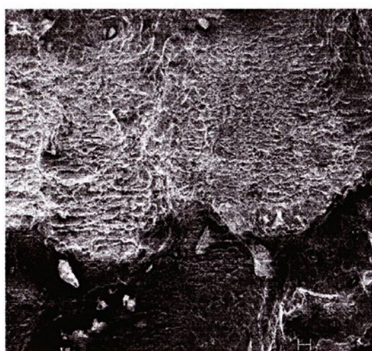
c) 2 ciclos + recozimento a 800°C (500x)
