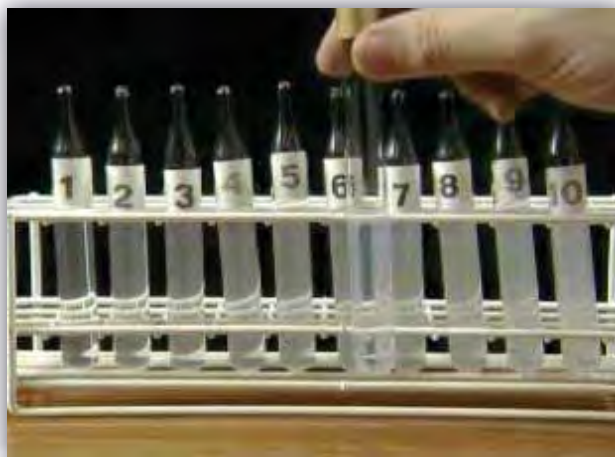
Figura 9: Escala de McFarland numerada, contendo diferentes concentrações de sulfato de bário, correspondente a diferentes contagens bacterianas.
