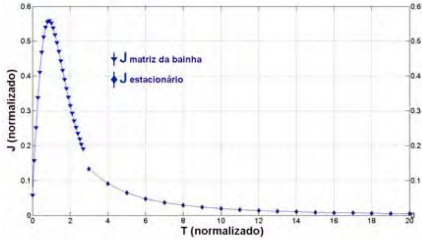
Figura B.3: Densidade de corrente de implantação iônica usando o modelo de Lieberman.
