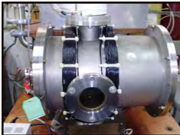
Figura 6.2: Bobinas magnéticas construídas sobre a câmara 3IP e posicionado de lado da janela.
