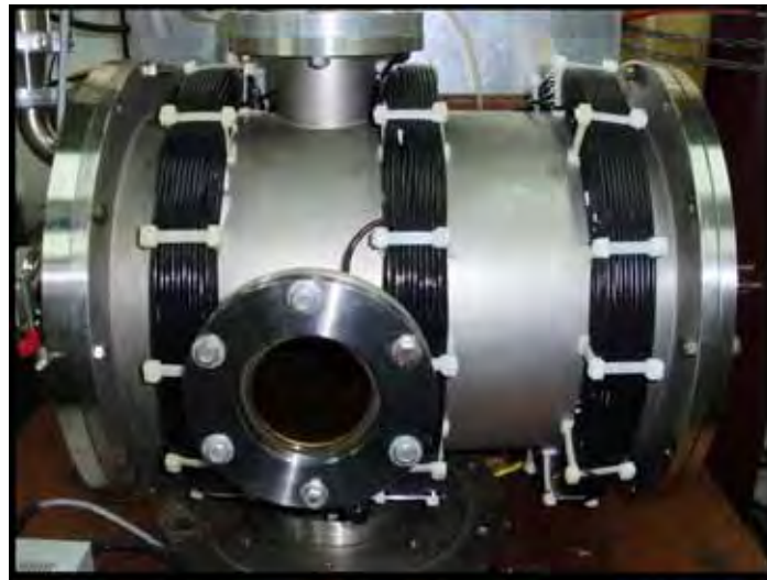
Figura 6.13: Conjunto de três bobinas magnéticas usadas para o mapeamento de \mathbf{B} .
