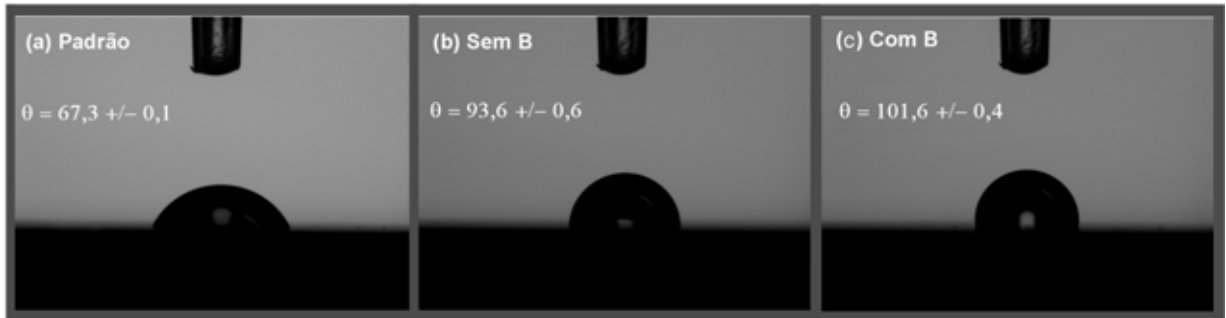
Figura 8.8: Medida do ângulo de contato em tensão de 3,0 kV e pressão 0,94 Pa.
