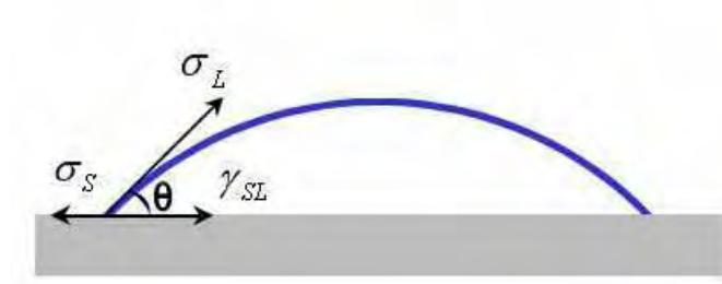
Figura D.2: Desenho ilustrativo das forças agindo entre uma gota líquida e a superfície de um material.
