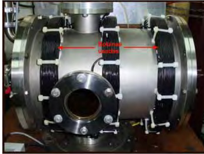
Figura 6.8: Conjunto de bobinas magnéticas usadas para o mapeamento do campo B .
