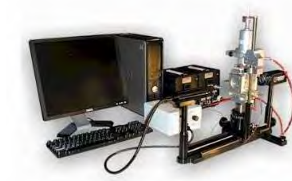
Figura D.4: Dispositivo usado para o cálculo da medida do ângulo de contato conhecido como Goniômetro.
