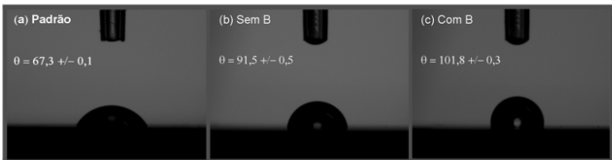
Figura 8.9: Medida do ângulo de contato em tensão de 3,0 kV e pressão 2,10 Pa.
