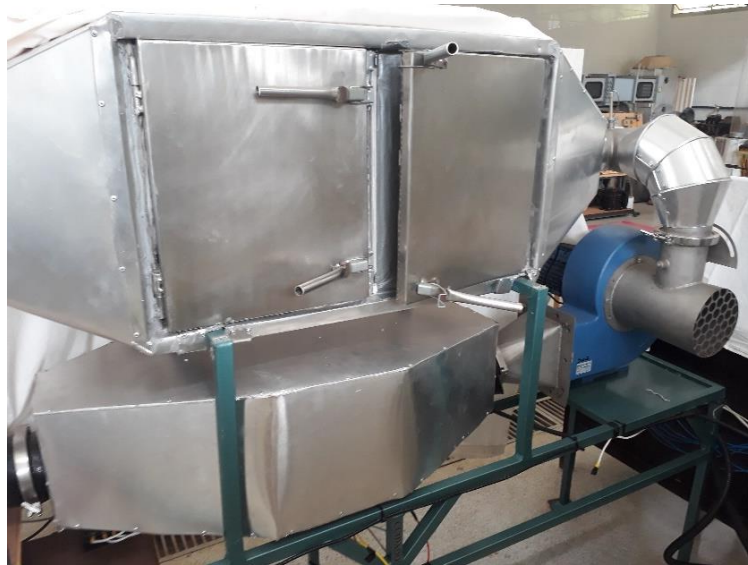
Figura 4.3 – Secador de leito fixo com convecção forçada utilizado no processo de secagem
