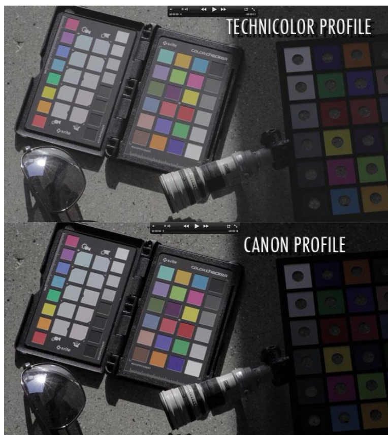
Figura 20 – Exemplo de imagem com CineStyle e com o perfil padrão da câmera. Fonte: http://blog.vincentlaforet.com/wp-content/uploads/Styles.jpg
