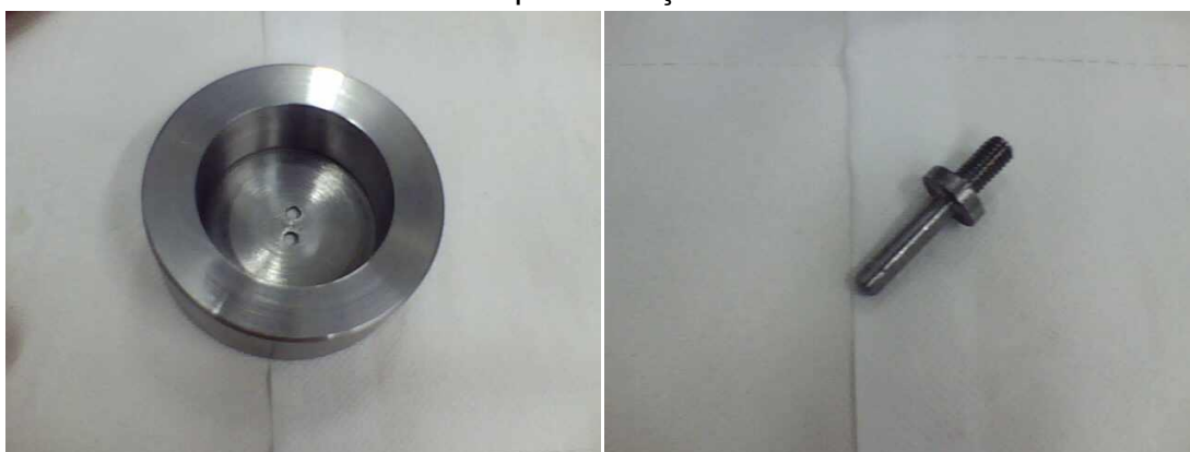
Figura 66 - À esquerda está o disco em forma de copo, feito de aço 8640, à direita está o pino de aço 4140.
