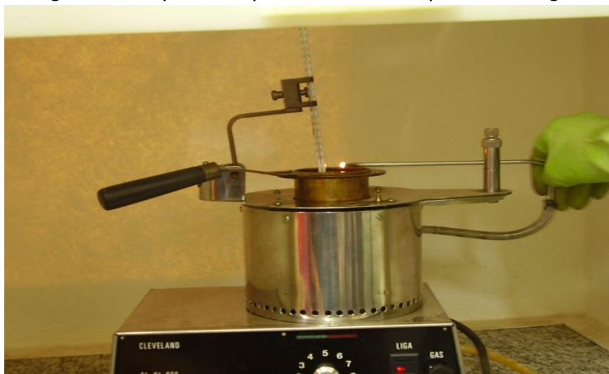
Figura 58 - Aparato e procedimento do ponto de fulgor.
