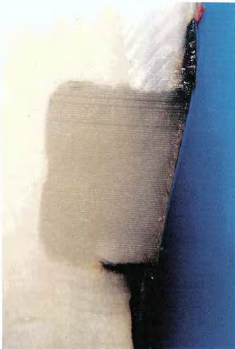
FIGURA 11 – Microinfiltração Grau 2 na margem gengival do espécime do G6.
