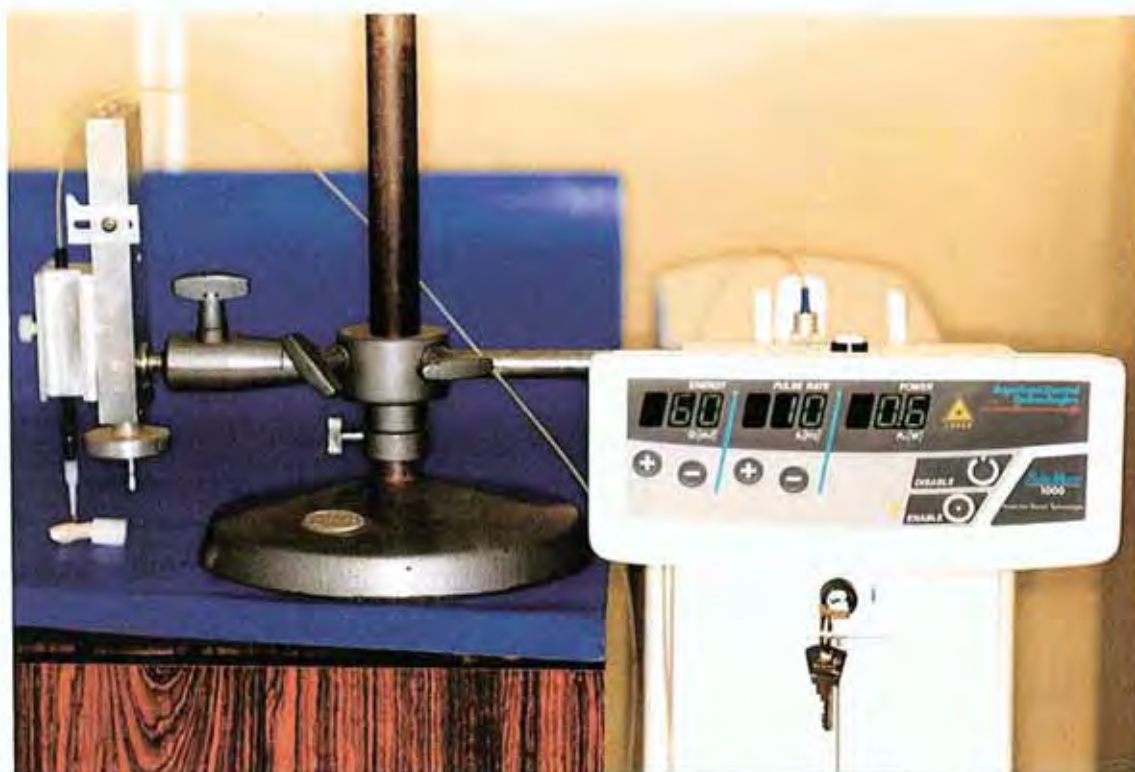
FIGURA 2 – Aparelho de Laser Nd:YAG ( ADT ) acoplado ao sistema de suporte.
