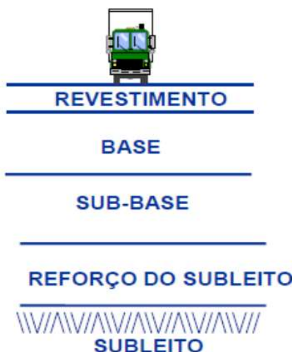
Figura 2 – Estrutura do pavimento asfáltico flexível.
