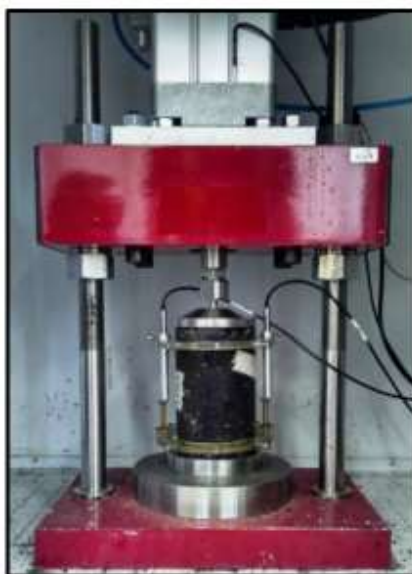
Figura 16 - Esquema de montagem do ensaio de Flow Number (FN).
