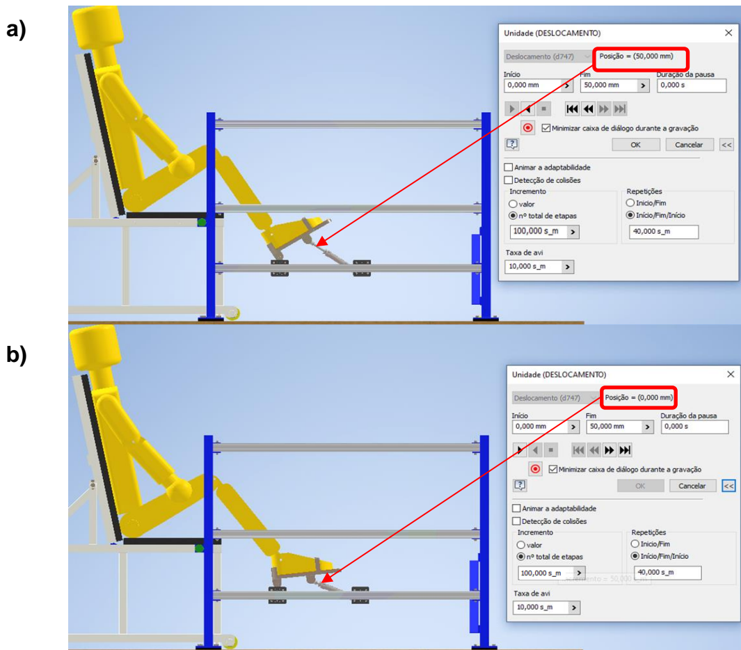
Figura 83 – Simulação do módulo N°04, modo: a) Dorsiflexão e b) Flexão plantar.
