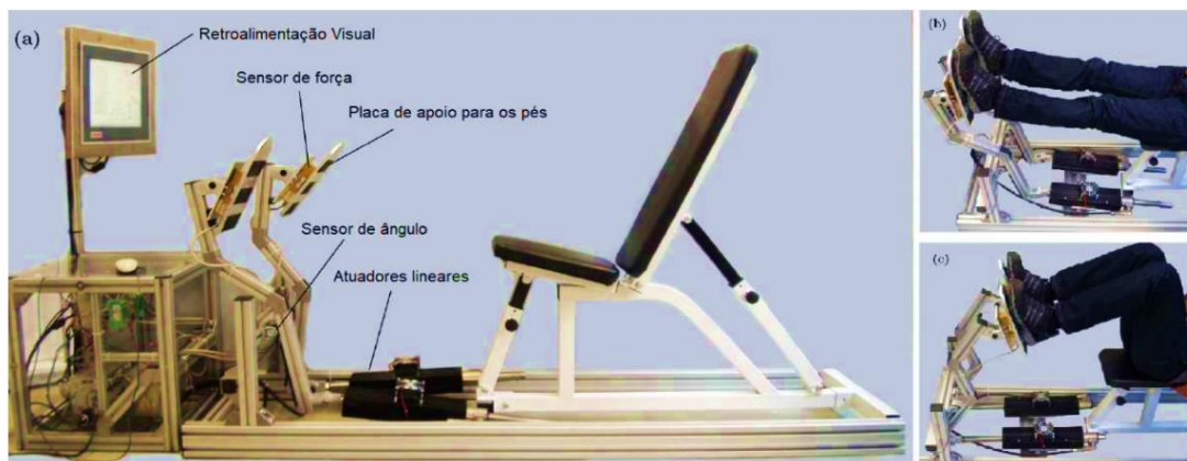
Figura 15 – Dispositivo pediátrico dos membros inferiores: (a) Partes do dispositivo; (b) Extensão dos atuadores lineares; (c) Flexão dos atuadores lineares.
