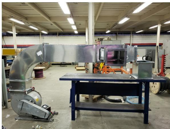
Figura 12 – Duto acoplado no ventilador.
