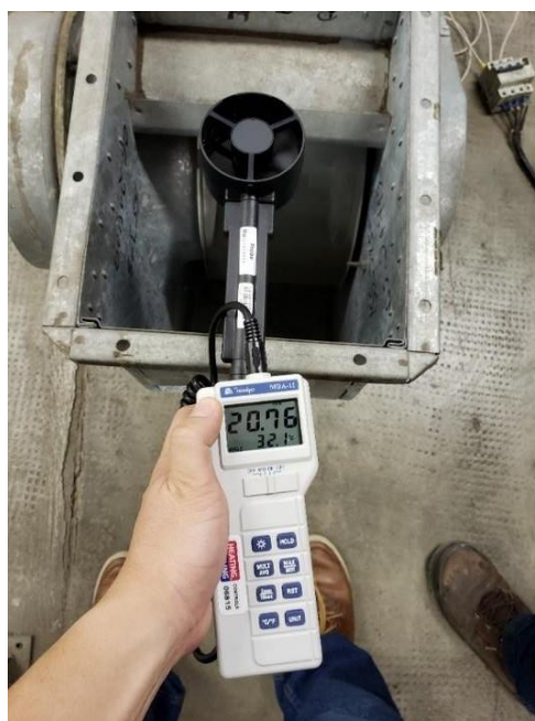
Figura 10 – Manuseio do anemômetro
