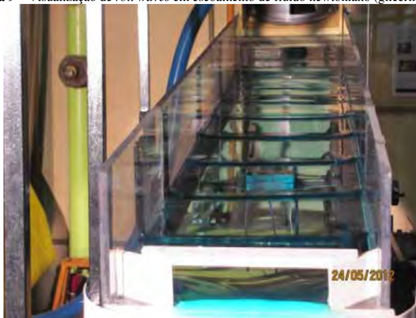
Figura 9 – Visualização de roll waves em escoamento de fluido newtoniano (glicerina pura)
