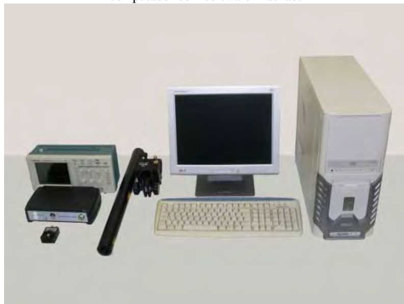
Figura B.3: Conjunto do sistema de aquisição. Da esquerda para a direita: osciloscópio, laser He-Ne 633 nm, computador com software MatLab.
