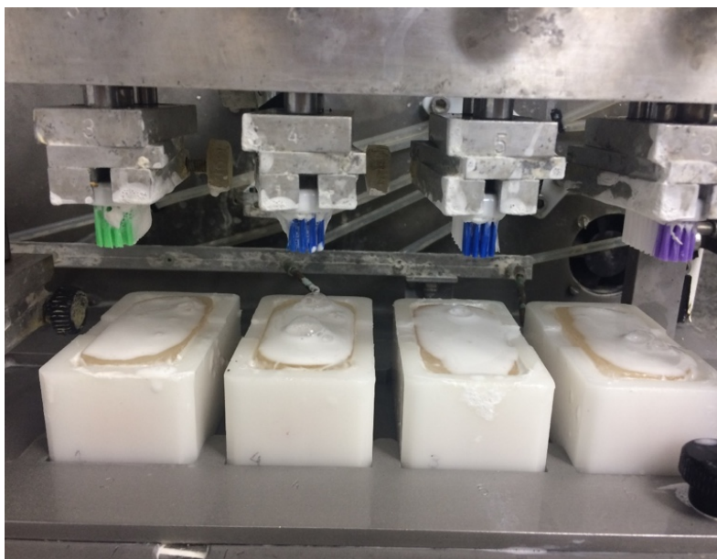
Figura 6- Suportes e escovas posicionados na máquina de escovação
