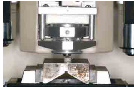
FIGURA 15 - Microdurômetro Shimadzu Micro Hardness Tester HMV-2000 (Shimadzu Corporation, Kyoto, Japan), com penetrador tipo Knoop, acoplado ao Software para análise de imagem CAMS-WIN (NewAge Industries, USA).
