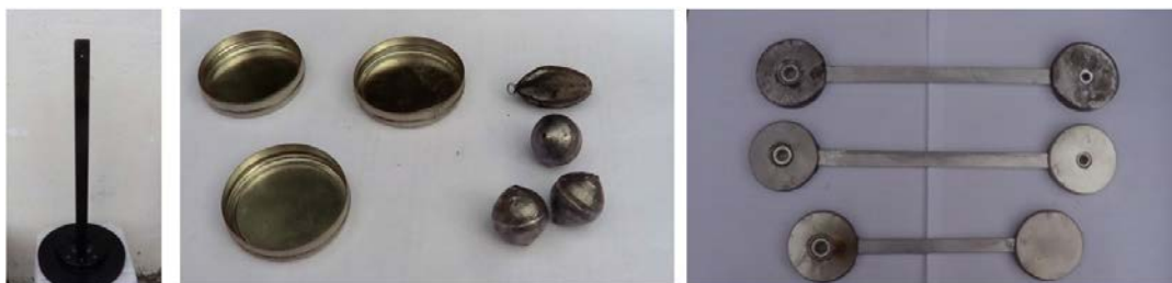
Figura 5.1: Haste de alumínio para suporte do pêndulo (esquerda), tampas de alumínio e chumbo para construção das massas (centro) e braços prontos para serem acoplados (direita).
