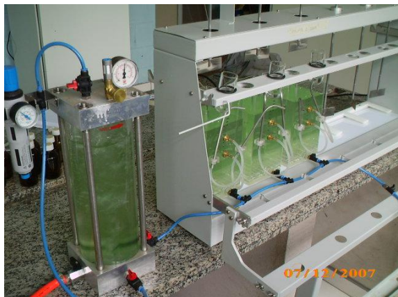
Figura 5.2 – Ensaio em bancada, floteste, com água preparada em laboratório.
