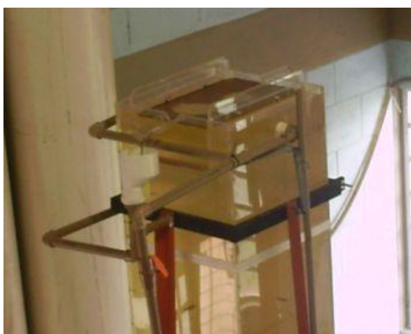
Figura 5.40 – Formação da manta na saída do sistema flotador.
