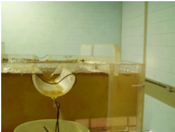
Figura 5.52 – Lodo flotado em câmara de flotação sendo descartado durante terceiro ensaio com água misturada
