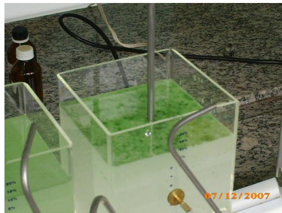
Figura 5.3 – Formação de lodo flotado em ensaio de bancada, com água preparada em laboratório.
