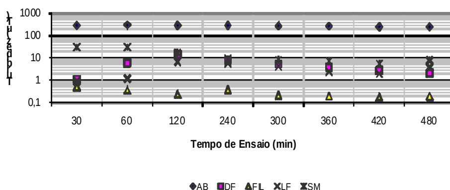
Figura 5.41 – Valores de turbidez. Ensaio 1, segunda bateria da ETAPA 3. Taxa de 120 m 3 /m 2 .dia, DSA de 30 mg/L, Sem recirculação na unidade de FAD.
