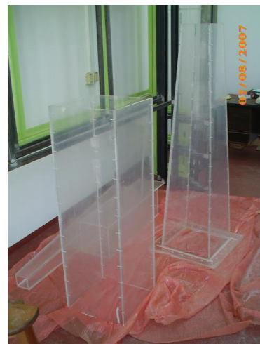
Figura 4.6 – Câmara de flotação externa, pirâmide do floculador.
