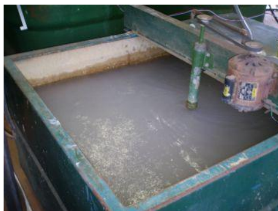
Figura 4.16 – Reservatório de 1000 L com agitador mecânico para preparo da água
