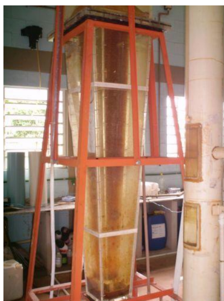
Figura 5.19 – Formação da manta de lodo no flocculador.
