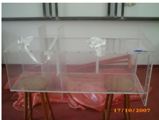
Figura 4.10 – Câmara de flotação, fase de construção.
