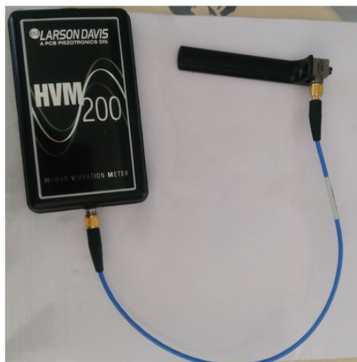
Figura 4.5: Equipamento de aquisição de sinais (a); Acelerômetro fixado no adaptador tipo Barra (b)
