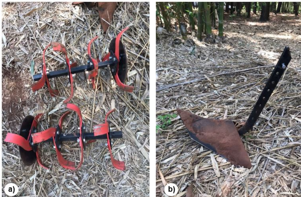
Figura 4.2: Ferramentas agrícolas: Enxada rotativa (a); Sulcador (b)
