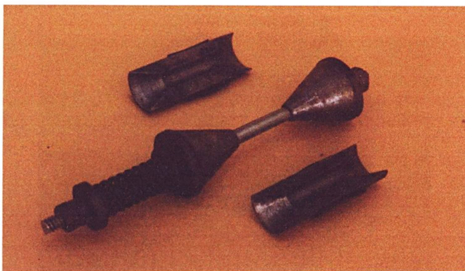
Figura A.1 - Dispositivo de compressão dos extensômetros elétricos de resistência.
