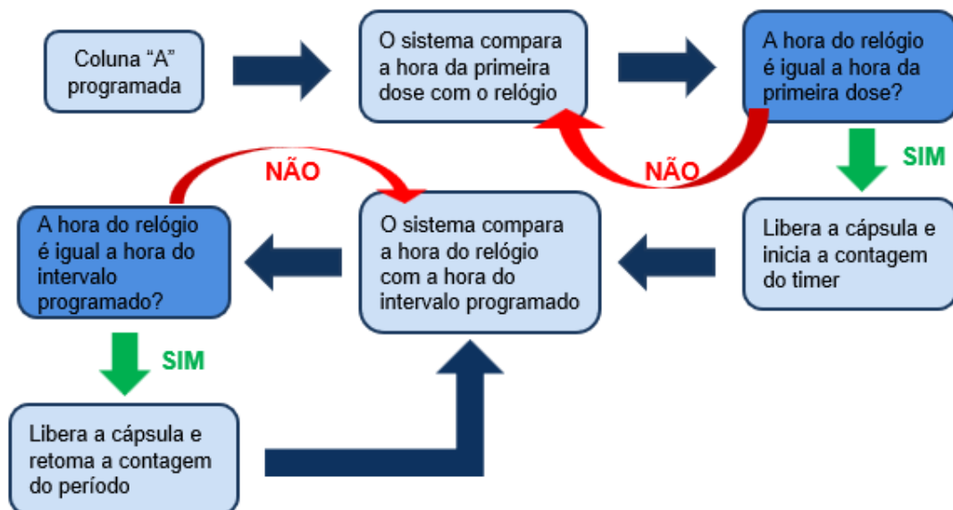
Figura 16 - Fluxograma de funcionamento de cada coluna.
