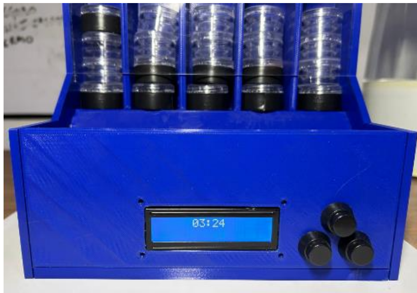
Figura 34 - Painel de frontal com display LCD e botões.
