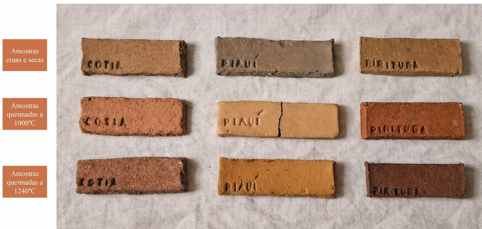
Figura 21 – Diferenças de cor das argilas testadas nas etapas úmida, seca, após a queima de biscoito e após a queima de alta temperatura
