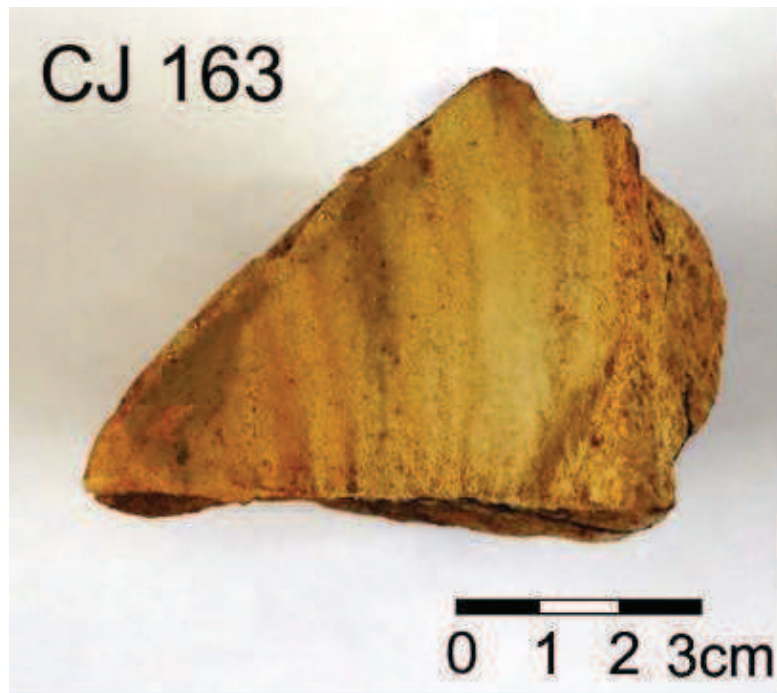
Figura 8.61. Amostra do ponto CJ 163. Arenito Laminado amarelo com granulação fina.
