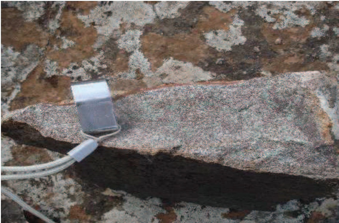
Figura 8.20. Basalto de coloração cinza clara, estrutura isotrópica e textura fanerítica equigranular média, com presença de minerais de coloração verde (seladonita).
