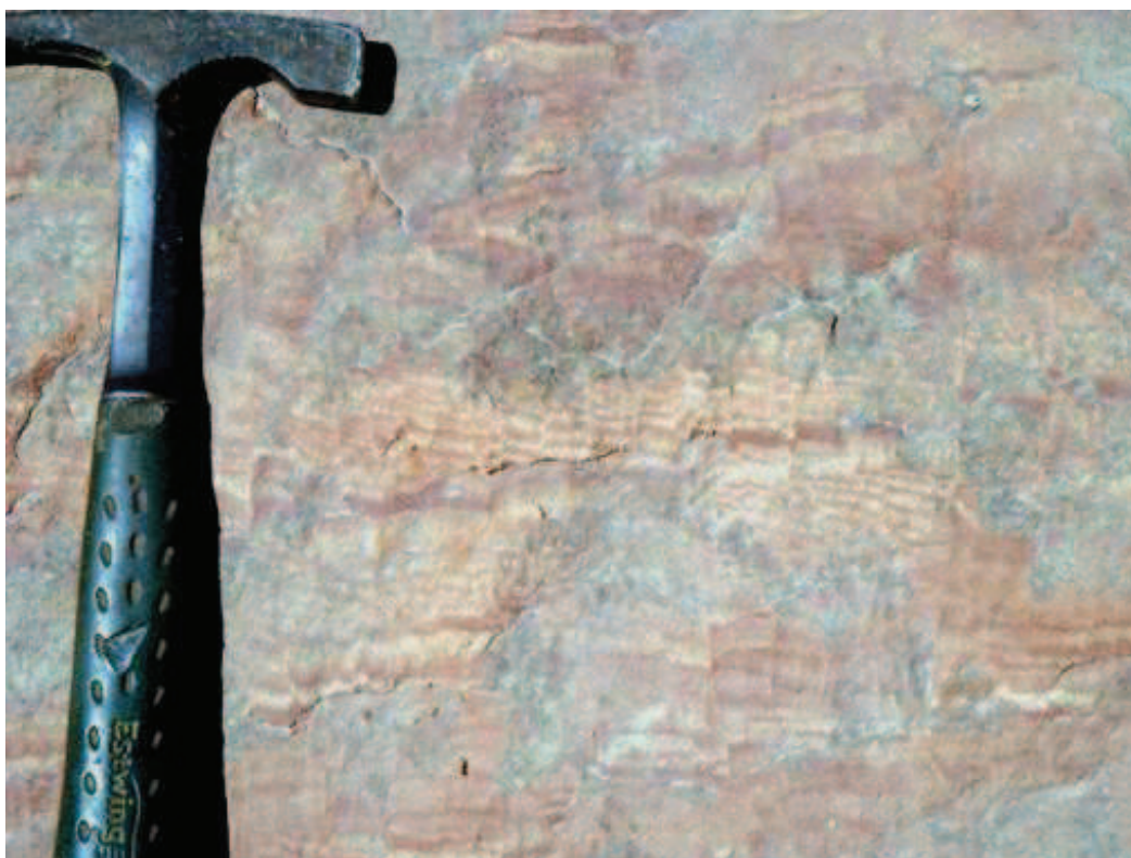
Figura 9.29. Bandas de deformação no arenito laminado com separação sinistral. Ponto CJ 164. Vista em planta.
