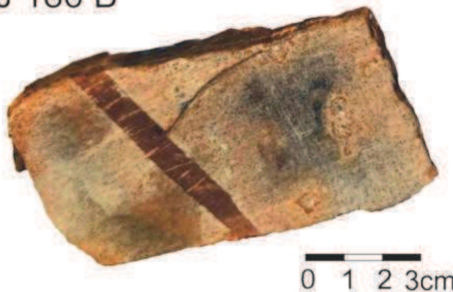
Figura 8.41. Rocha de coloração cinza a avermelhada. Apresenta textura subfanérita equigranular fina com presença de veio do Tipo 2, formado por quartzo. Ponto CJ 186.
