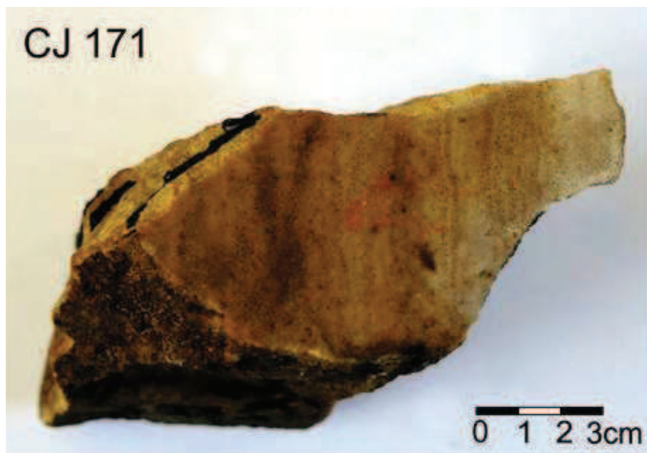
Figura 8.55. Amostra de mão do ponto CJ 171 de Arenito Homogêneo, com grãos subarredondados e granulação fina a média.
