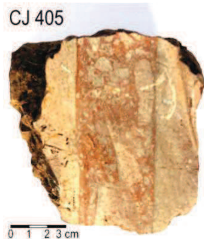
Figura 8.39. Basalto Ponto CJ 405 evidenciando o veio avermelhado do Tipo 1, preenchendo fraturas existentes na rocha. Nota-se a presença de fragmentos de basalto no veio.
