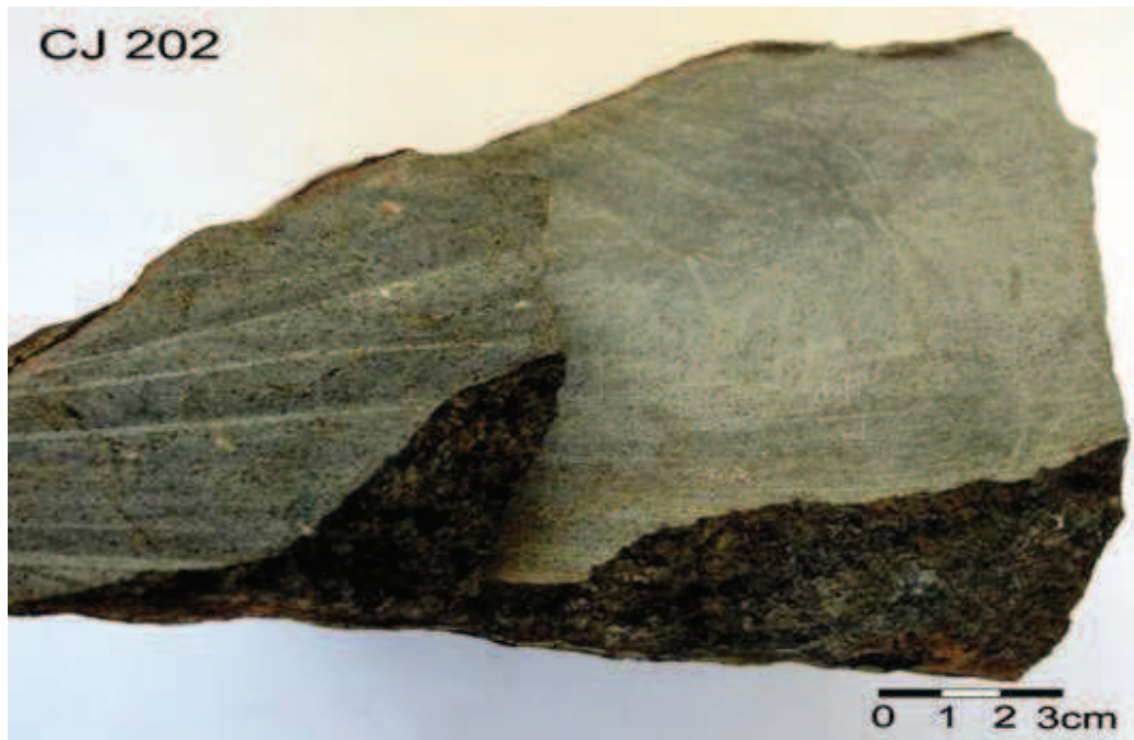
Figura 8.13. Basalto de coloração cinza clara com estrutura isotrópica e textura subfanerítica equigranular fina.
