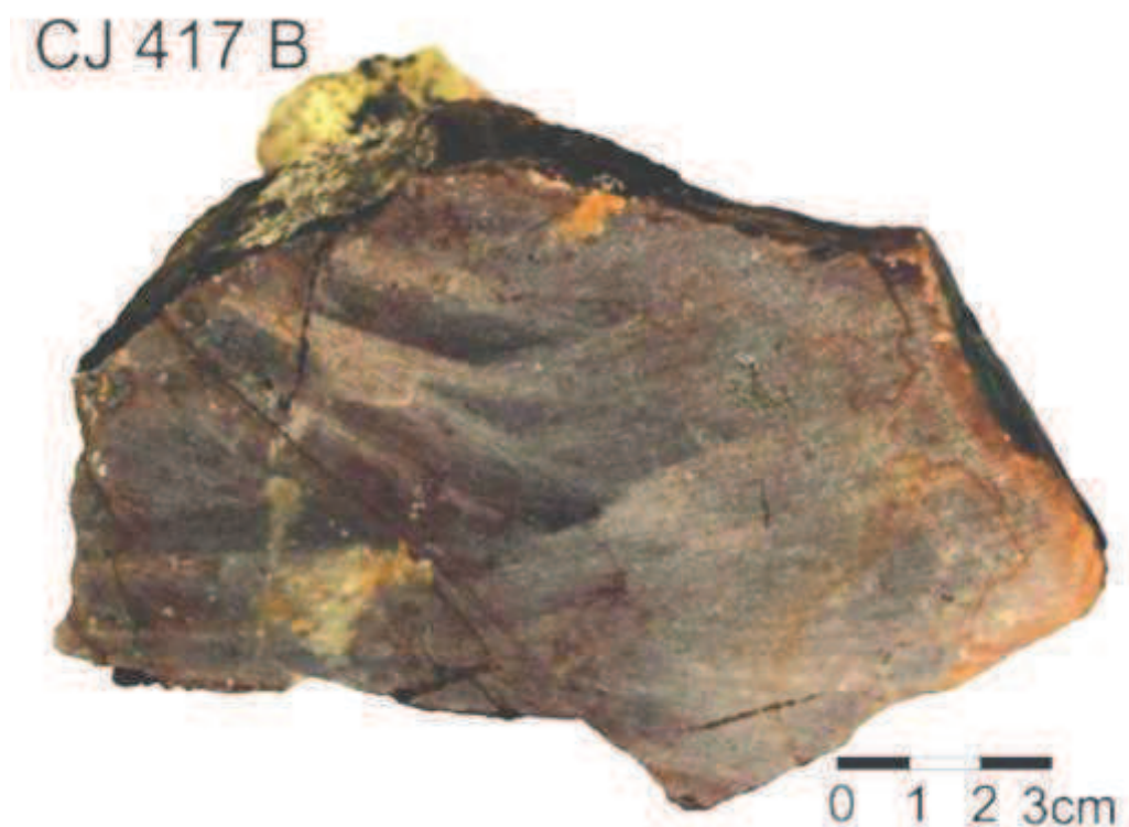
Figura 8.16. Basalto de coloração cinza a avermelhado, com estrutura isotrópica e textura subfanerítica equigranular fina, com porção de alteração na borda da amostra.
