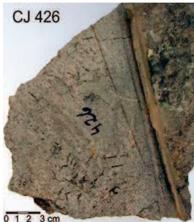
Figura 8.37. Amostra de mão do Ponto CJ 426, basalto equigranular fino, com textura afanítica. Presença de veios avermelhados do Tipo 1, que são preenchidos por material fino. Seção do lado esquerdo da amostra serrada.
