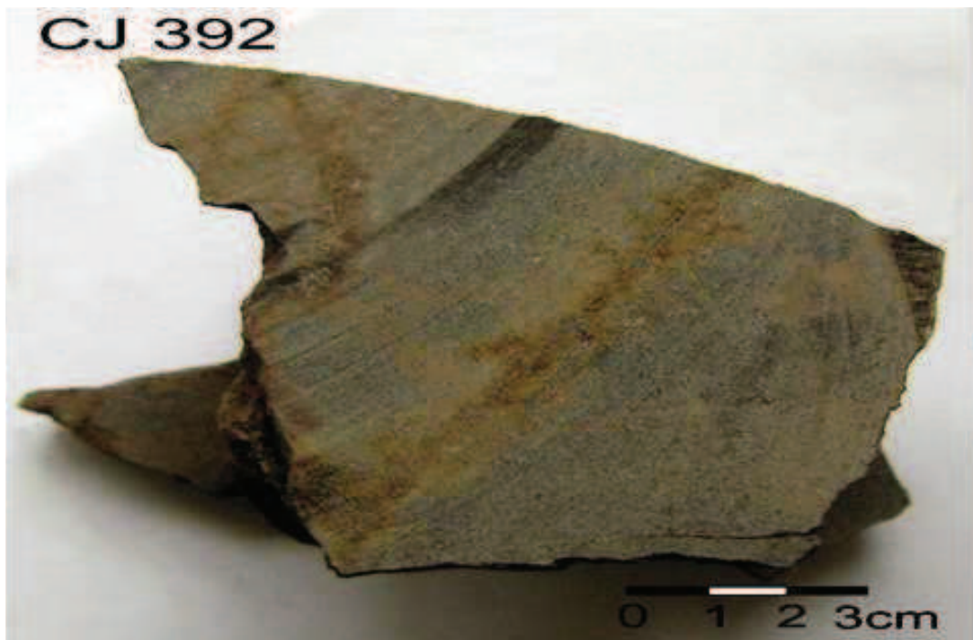
Figura 8.6. Basalto de coloração cinza claro com estrutura isotrópica e textura subfanerítica equigranular fina. Apresenta bandamento.
