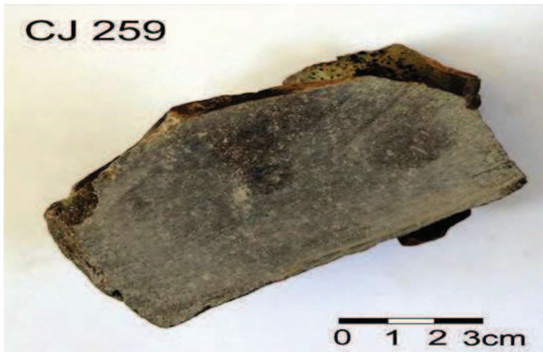
Figura 8.9. Basalto de coloração cinza claro, com estrutura isotrópica, de textura afanítica.
