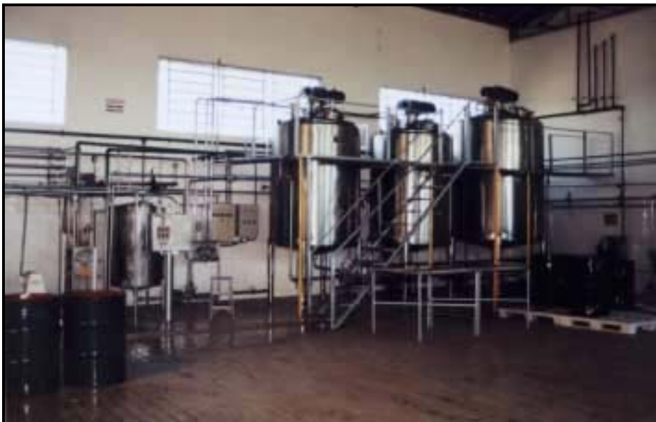
Foto 12: Tanques utilizados para a pasteurização da polpa de frutas, utilizada para o beneficiamento de acerola na Agroindústria Fruteza, município de Dracena-SP.
