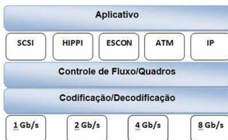
Figura 6 – Pilhas de protocolos Fibre Channel.
