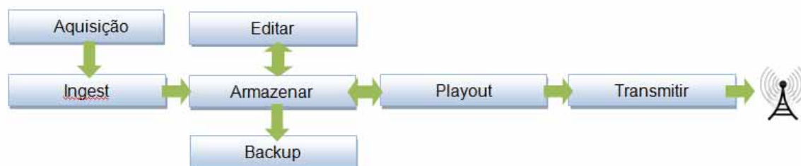
Figura 34 – Fluxo de Dados da Emissora TV Unesp – Da Aquisição à Transmissão
