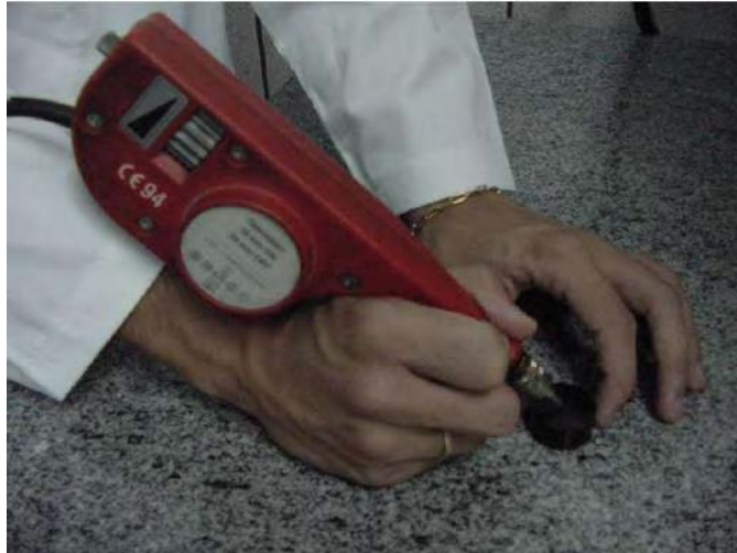
Figura 41 - Marcação e identificação das amostras utilizando gravador elétrico vibrador.
