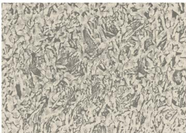
Figura 34 - Fotomicrografia de um aço ao carbono. Ataque Nital 2%. Aumento de 200 X.
