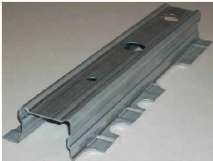
Figura 27 - Trecho de uma longarina que foi conformada em aço CP 800.
