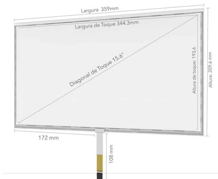
Figura 58 – Tela resistiva de 4 vias de dimensão 15,6 polegadas.
