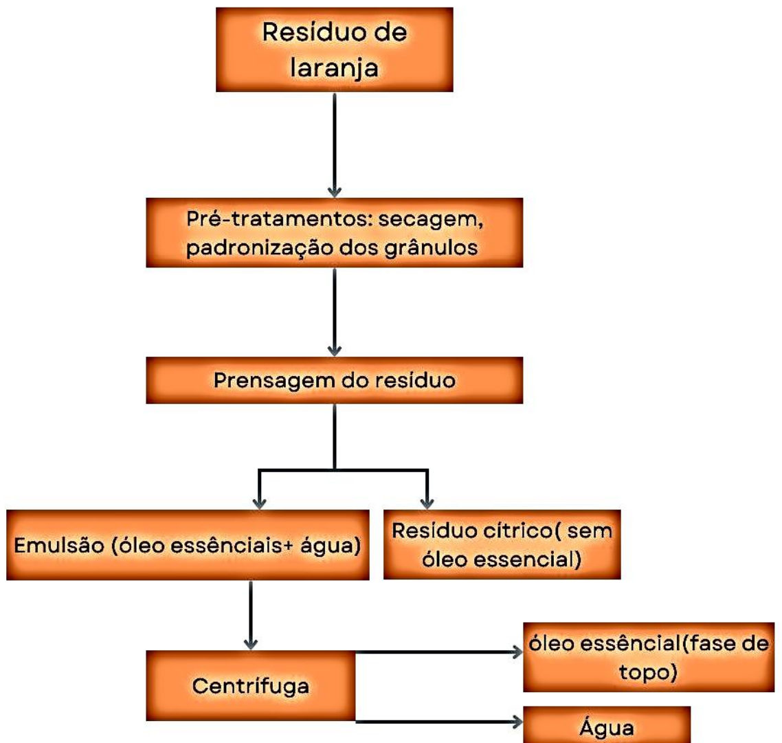
Figura 6 -Resumo de um processo tradicional da prensagem a frio
