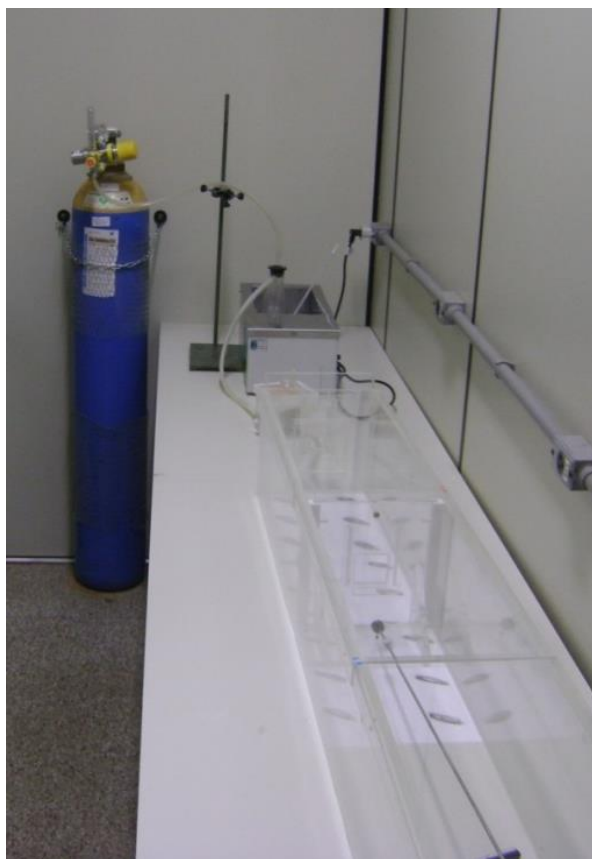
Figura 3. Túnel de vento utilizado nos testes de atratividade dos sistemas de liberação.
