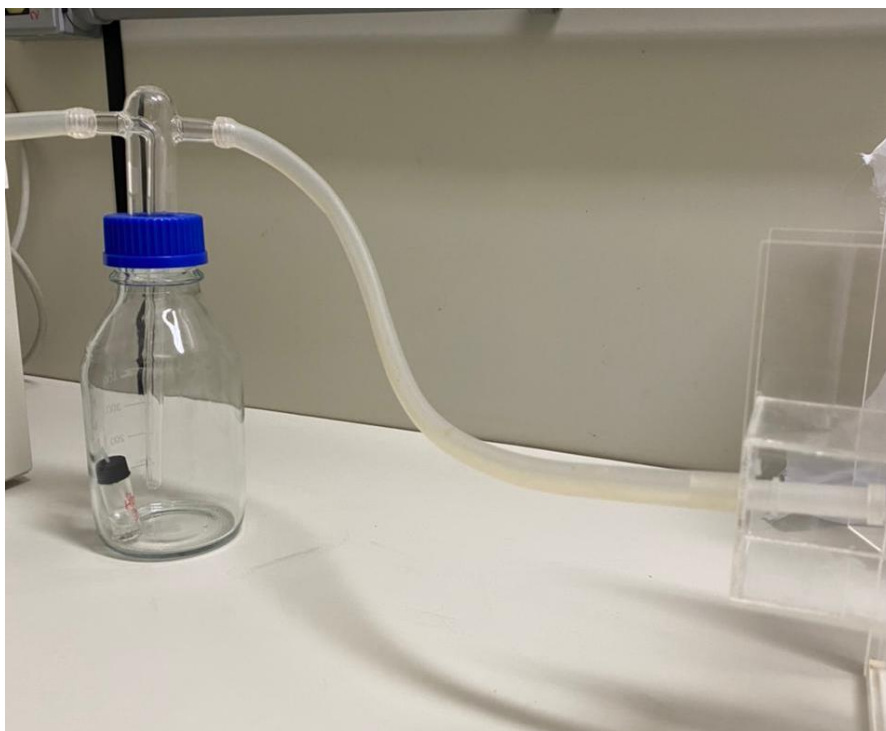
Figura 4. Adaptação para a utilização da garrafa lavadora de gás.
