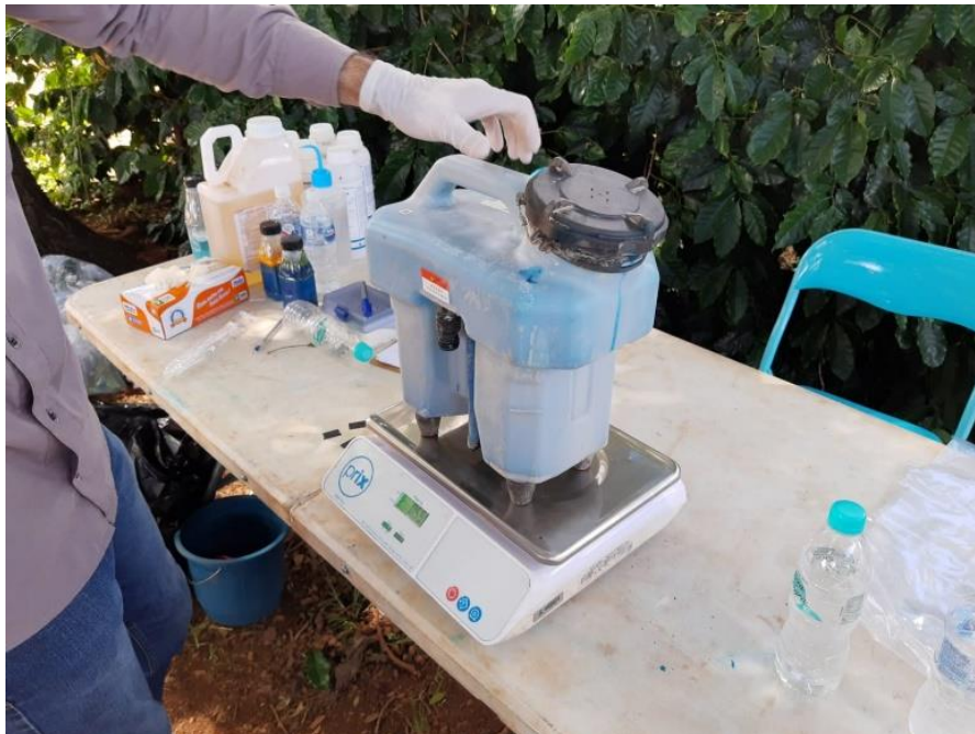
Figura 5 - Exemplo de medição da quantidade de líquido utilizado para pulverizar cada área da parcela, pesando a solução de pulverização para reabastecer o tanque após terminar a operação de pulverização
