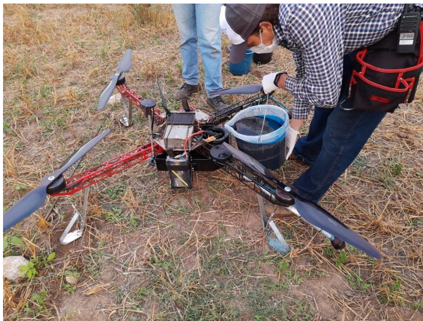
Figura 8 - Abastecimento do drone da ARPAC com a calda contendo o corante azul brilhante
