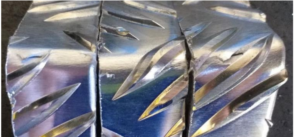
Figura 24 – Corpos de prova recozidos a temperaturas abaixo acima de 200°C após dobramento.
