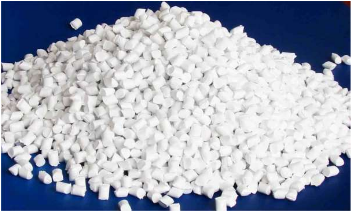
Figura 18 – Forma inicial do PET após a esterificação.
