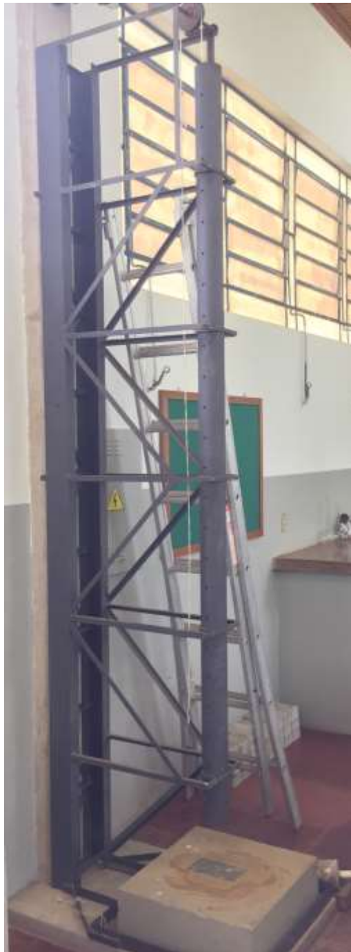
Figura 32 – Aparato utilizado para o ensaio de resistência ao impacto.
