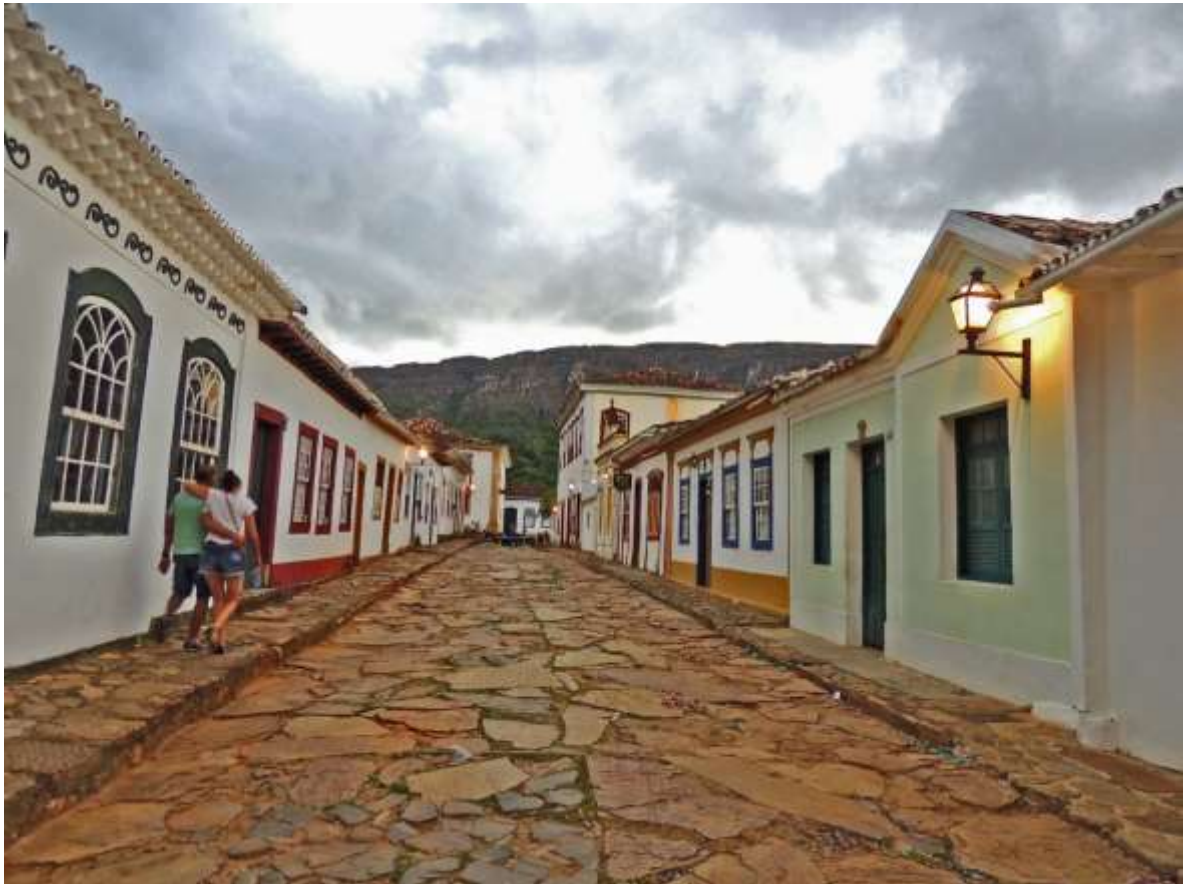
Figura 6 – Rua Direita em Tiradentes, MG, pavimentação em pé-de-moleque.
