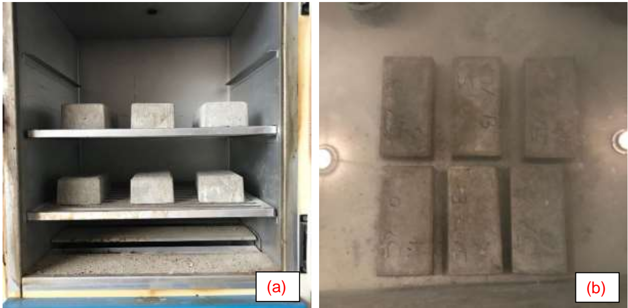
Figura 29 – (a) Disposição dos pavers na estufa; (b) Pavers imersos em água.
