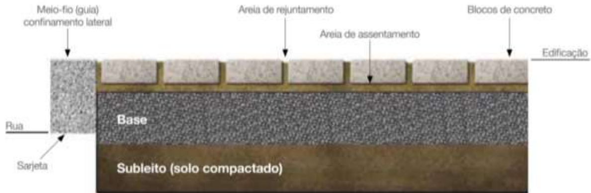
Figura 9 – Elementos constituintes do pavimento intertravado.
