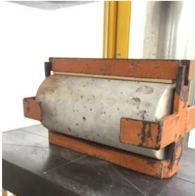
Figura 33 – Dispositivo para ensaio de compressão diametral.
