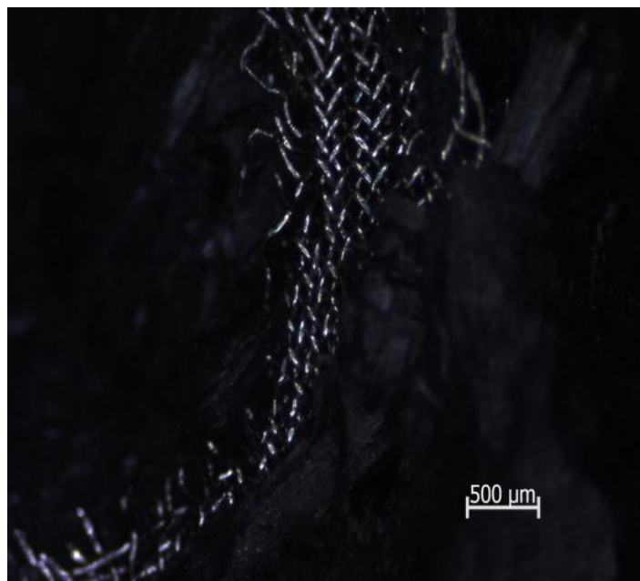
Figura 65-Interface do compósito soldado com malha metálica de 300 mesh após ensaio de Iosipescu.
