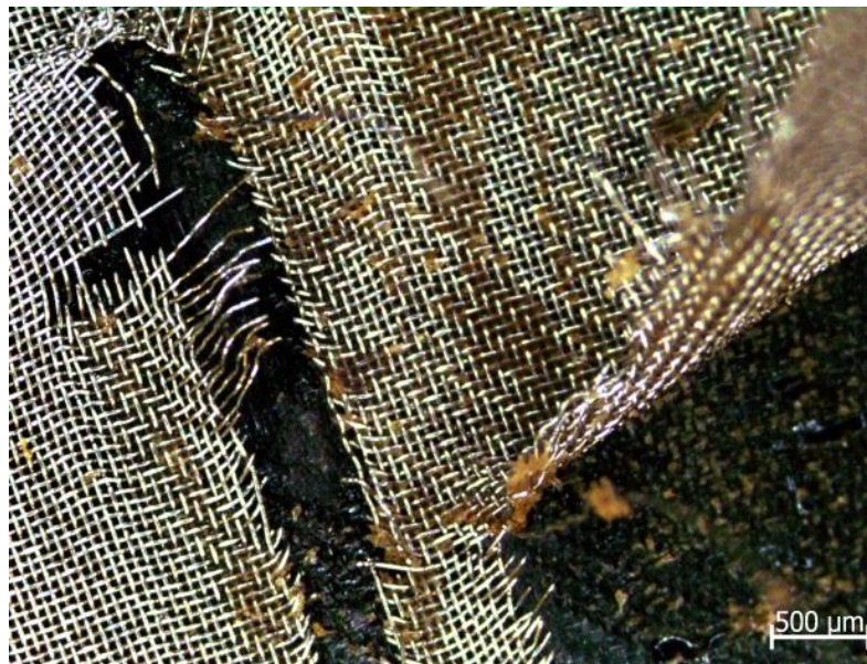
Figura 63-Compósito soldado com malha metálica de 300 mesh após ensaio lap shear .
