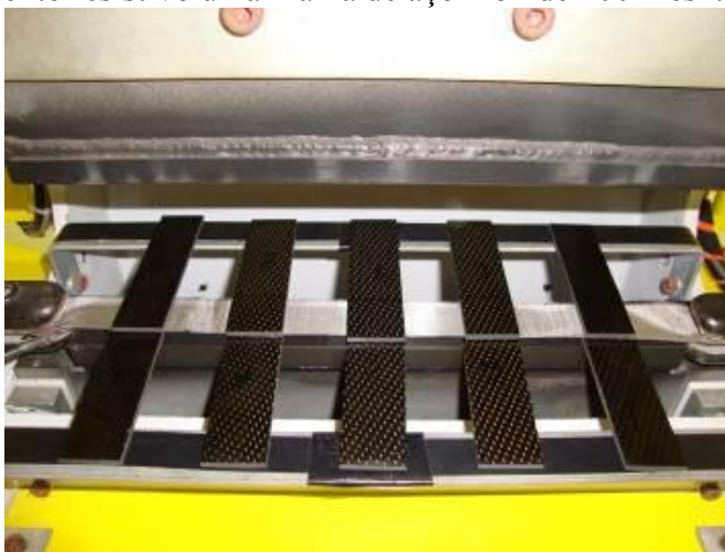
Figura 41-Amostras de PEI/fibras de carbono dispostas para a soldagem utilizando como elemento resistivo uma malha de aço inox de 100 mesh.
