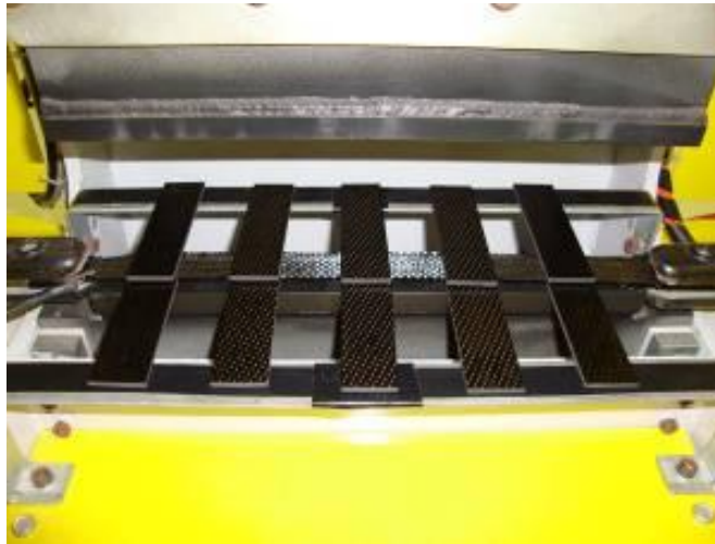
Figura 40-Amostras de PEI/fibras de carbono dispostas para a soldagem utilizando como elemento resistivo um tecido de fibra de carbono.
