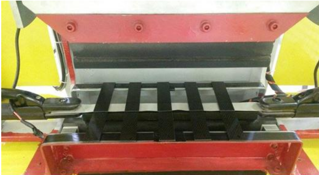
Figura 17-Posicionamento das amostras de lap shear na prensa.
