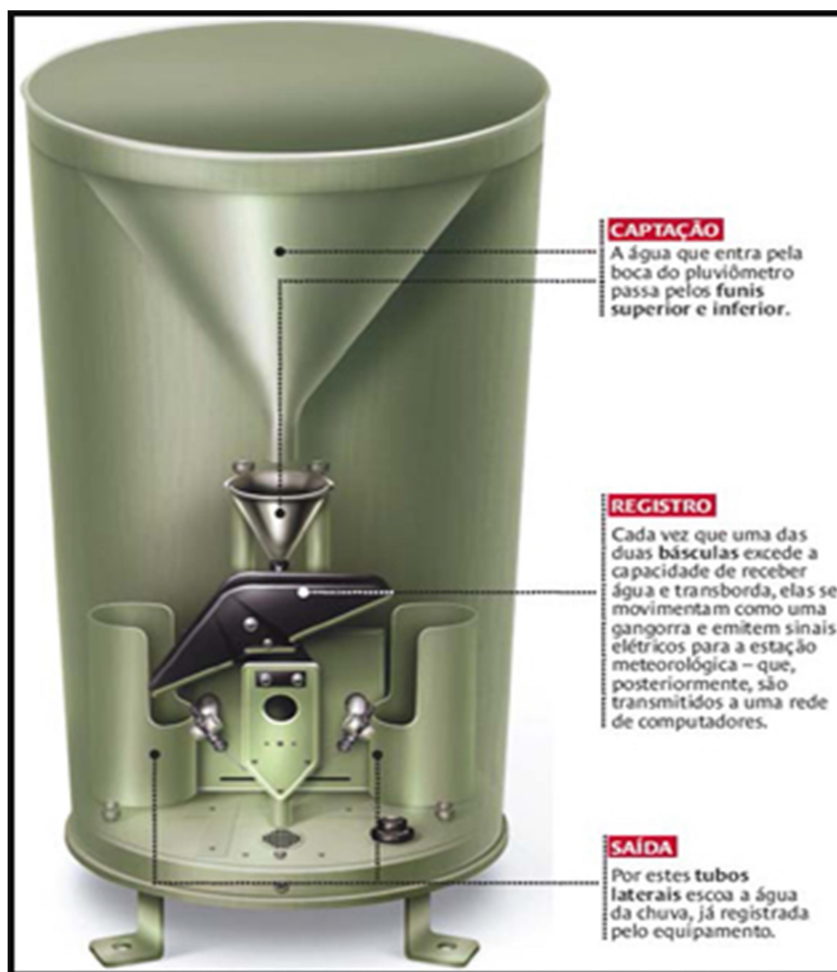
Figura 5 – Funcionamento de um pluviômetro de báscula
