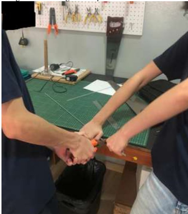
Figura 17: Estratégia usada para dividir a barra roscada
