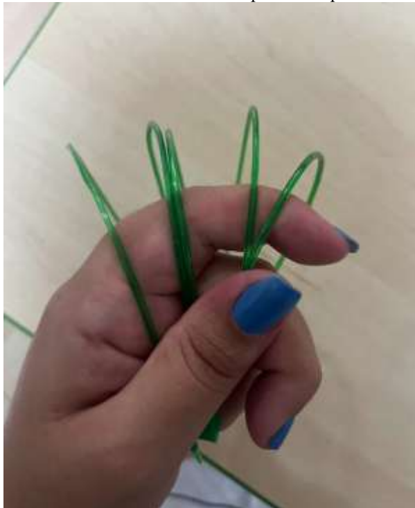
Figura 21: Foto de filamento de PET produzido pelos estudantes
