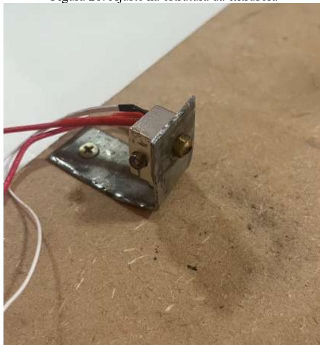
Figura 20: Ajuste na estrutura da extrusora
