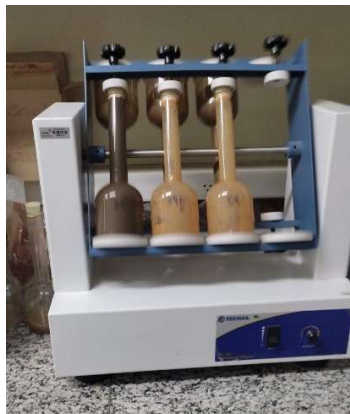
Figura 5.4. Agitador mecânico utilizado no preparo das amostras para o Ensaio de Sedimentação.
