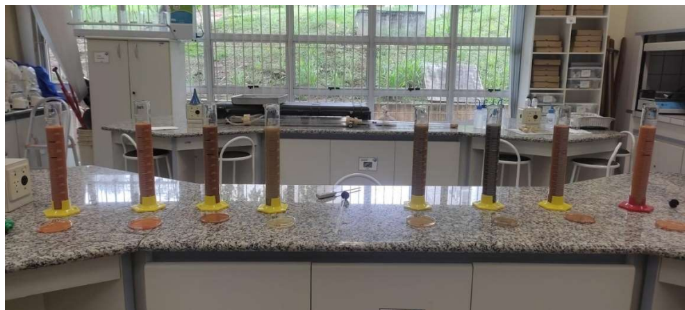
Figura 5.5. Análise granulométrica por sedimentação em provetas graduadas.
