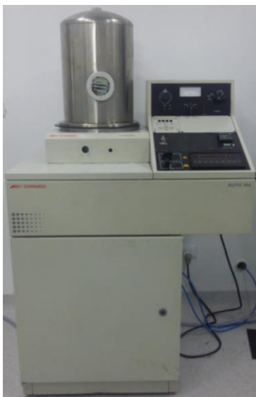
Figura 6 - a) Evaporadora Edwards 306 e b) padrões de eletrodos planares de alumínio obtidos utilizando a máscara de sombra da Ossila.
