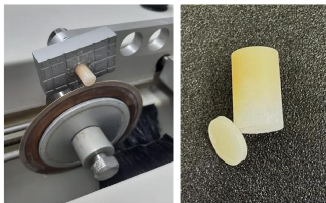
Figura 2. Imagem dos corpos de prova confeccionados com resina prensada para manufatura subtrativa (CAD/CAM).
