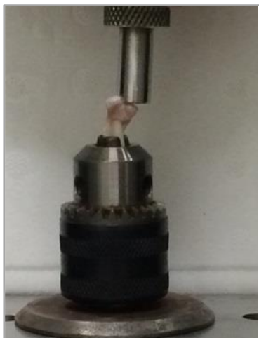
Figura 7 e 8: Ensaio mecânico de compressão no colo femoral.
