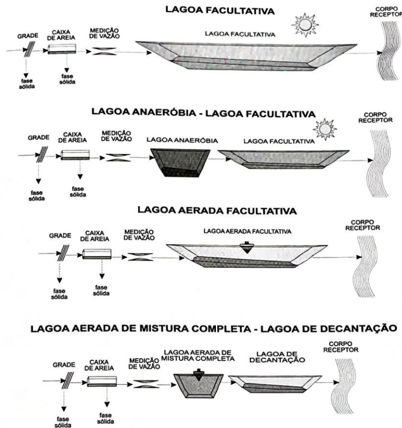
Figura 2 – Fluxograma dos principais sistemas de lagoas de estabilização.
