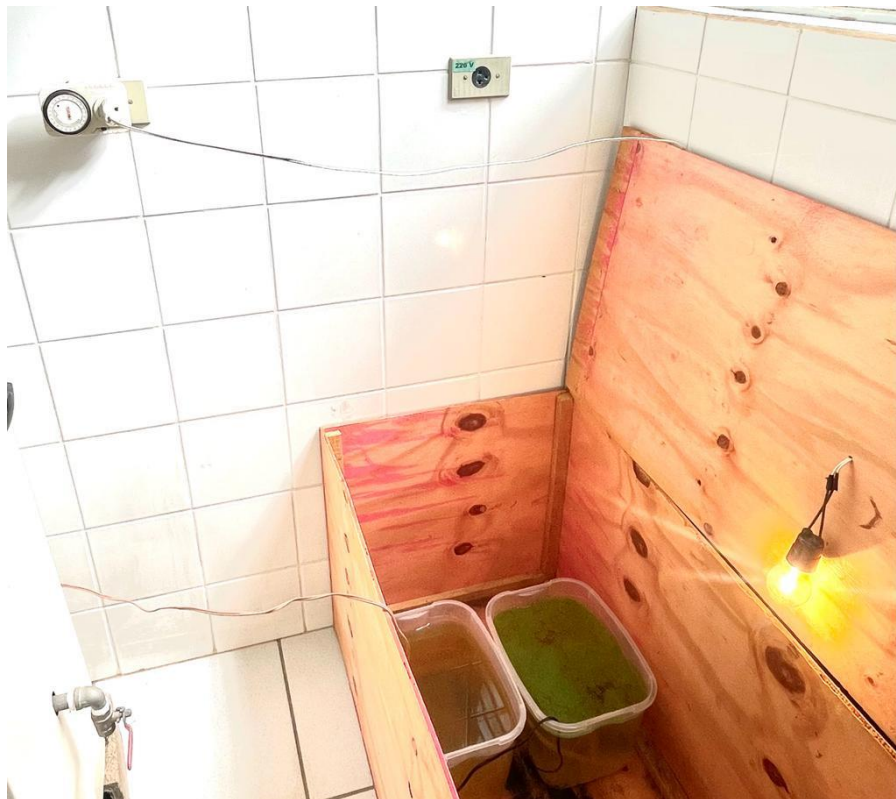
Figura 23 – Sistema de cultivo para experimento de bancada.
