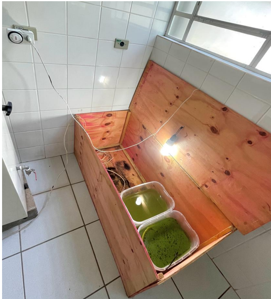
Figura 21 – Unidade experimental utilizada, contendo iluminação e caixas de cultivo.
