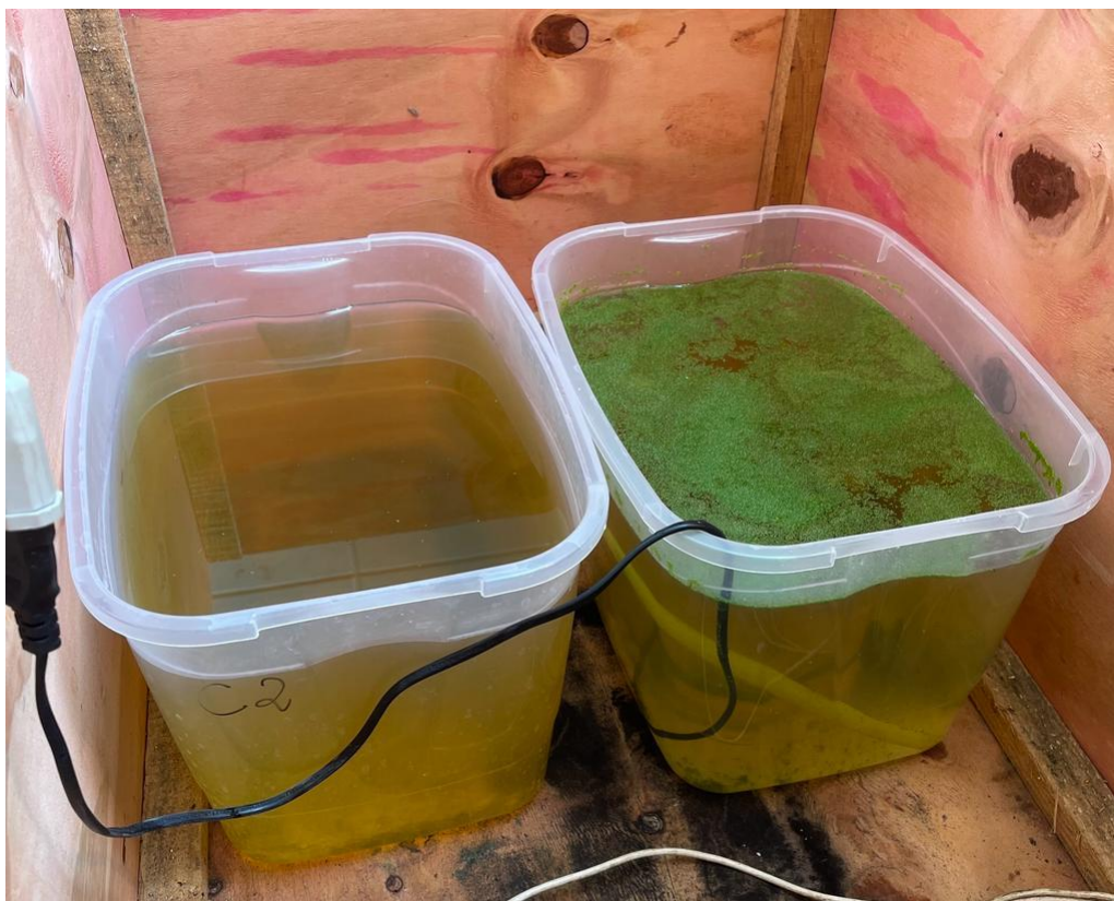
Figura 22 – Caixas de cultivo do experimento bancada.
