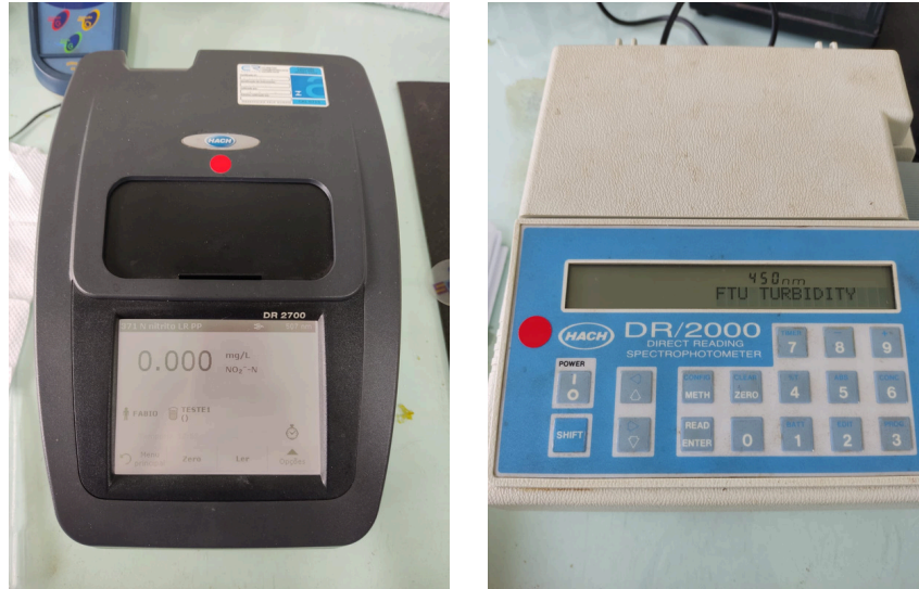
Figura 10 – À esquerda, espectrofotômetro HACH DR 2700 e à direita, espectrofotômetro HACH DR/2000.
