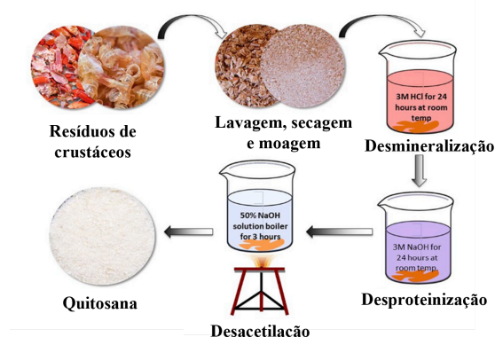
Figura 6 - Método convencional para extração da quitosana.
