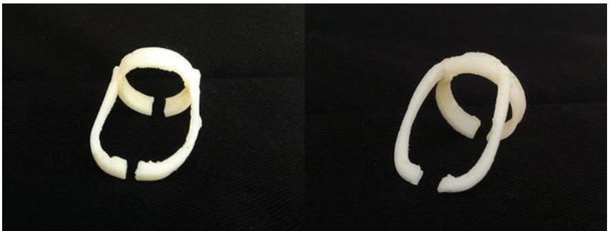
Figura 28 - Primeiros protótipos Impressos. Órtese Anelar Medial (esq) e Órtese Anelar Proximal (dir)
