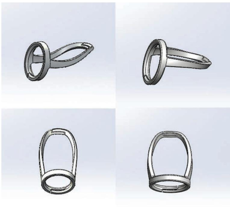
Figura 49 - Modelagem virtual dos Protótipos Finais. Órtese Anelar Medial (esq.) e Órtese Anelar Proximal (dir.)
