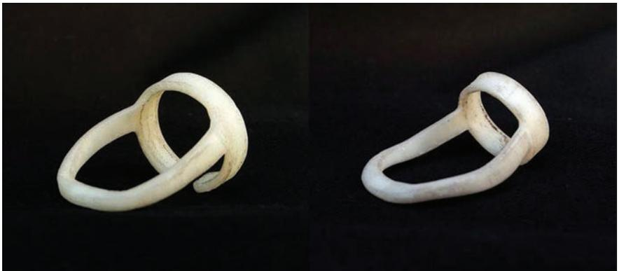
Figura 32 - Protótipos de Teste. Órtese Anelar Medial (esq.) e Órtese Anelar Proximal (dir.)
