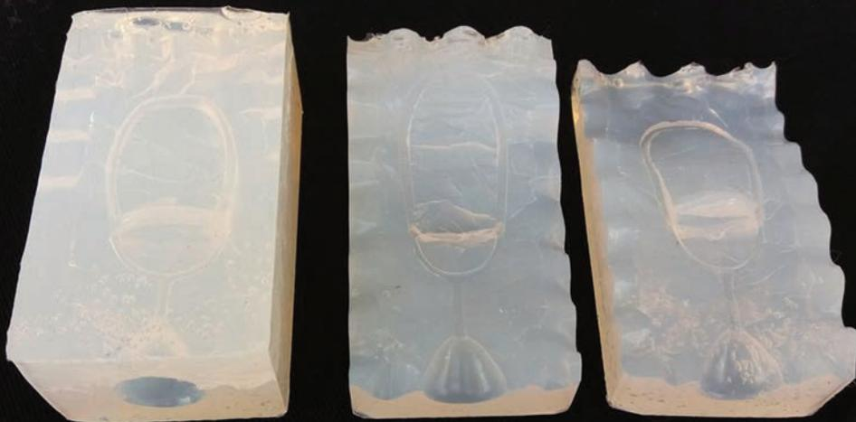
Figura 58 - Molde da Órtese Anelar Proximal (fechado a esquerda) e Molde da Órtese Anelar Medial (aberto a direita)
