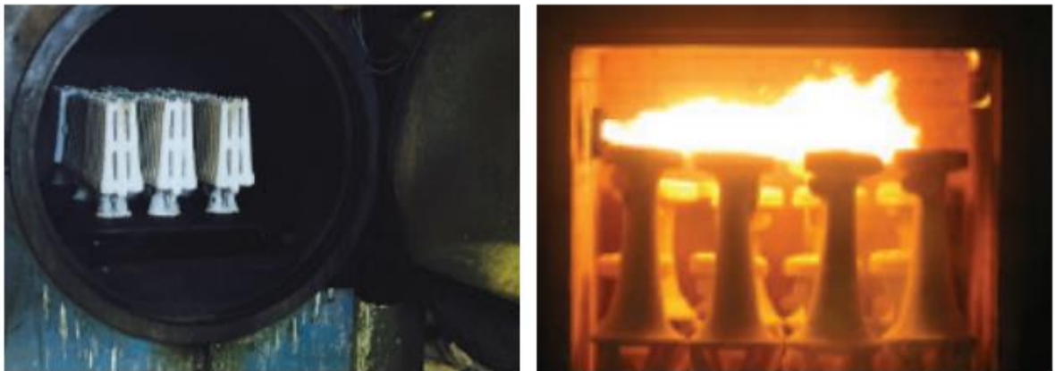
Figura 22 - Cachos entrando na autoclave para deceragem
