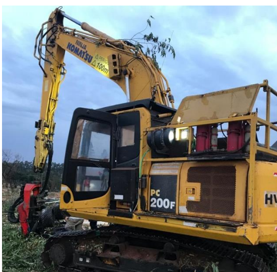
Figura 34. Máquina Komatsu em campo com o cabeçote Harvester
