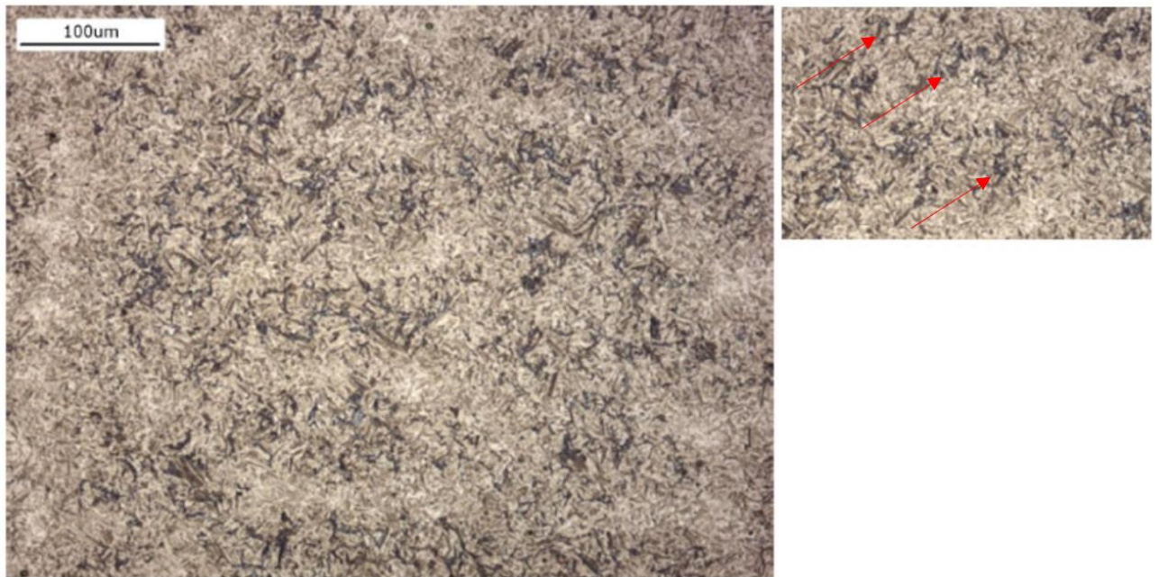
Figura 52. Análise Microscópica Coroa Microfundida (B), Corpo de Prova CPM-01.
