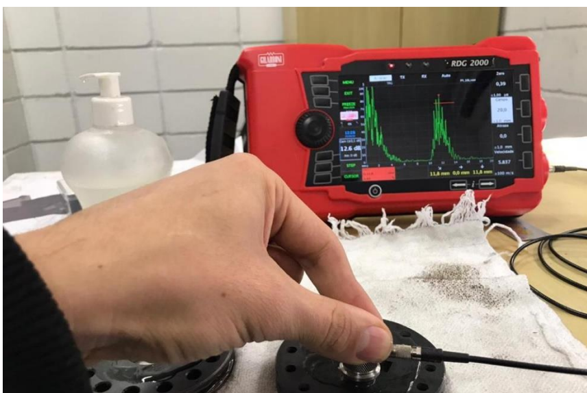
Figura 39. Aparelho de Ultrassom digital portátil.
