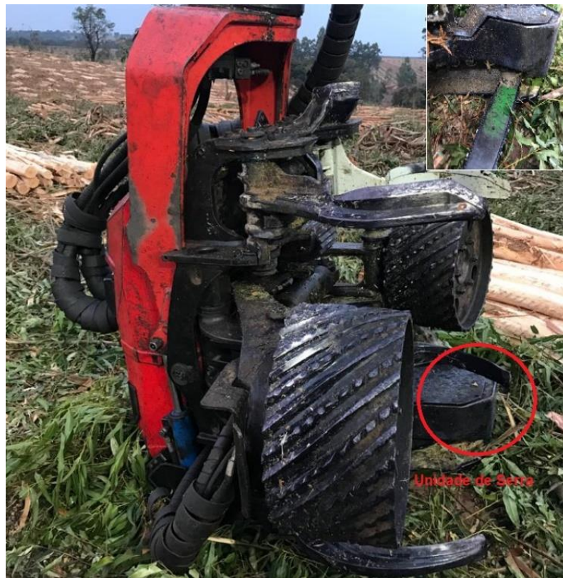
Figura 5. Um cabeçote Harvester com detalhe da unidade de serra.
