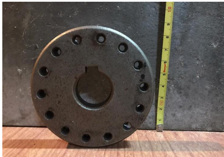
Figura 30. Coroa Microfundida SAE 8630 após processo de microfusão.
