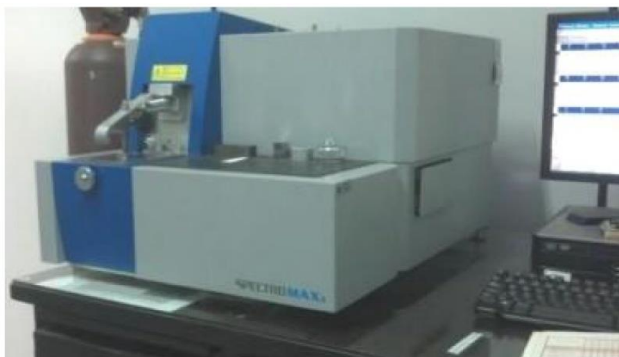
Figura 40. Espectrômetro utilizado para análise química das coroas, modelo SPECTROMAX.
