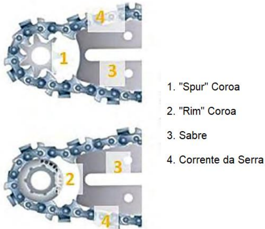
Figura 10. Montagem da coroa no conjunto de corte do Harvester .
