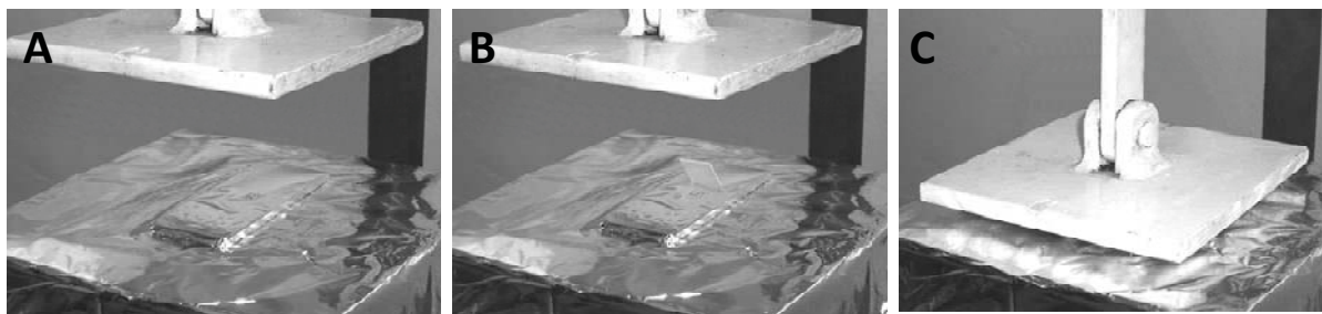
FIGURA 8 – Imagens das etapas de prensagem dos grãos no teflon PFA ® : A) Lâmina de alumínio com os grãos de zircão na chapa térmica; B) Pedaco de teflon PFA ® caindo por gravidade sobre os grãos de zircão; C) Segunda lâmina de alumínio sendo pressionada sobre a primeira para fixar os grãos de zircão no teflon PFA ® .
