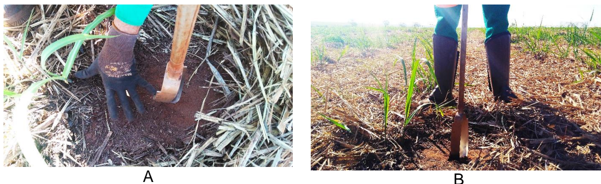
Figura 7. Ponto de amostragem (25 cm da linha de plantio da cana-de-açúcar) (a), Trado perpendicular ao solo para a retirada da amostra (b).
