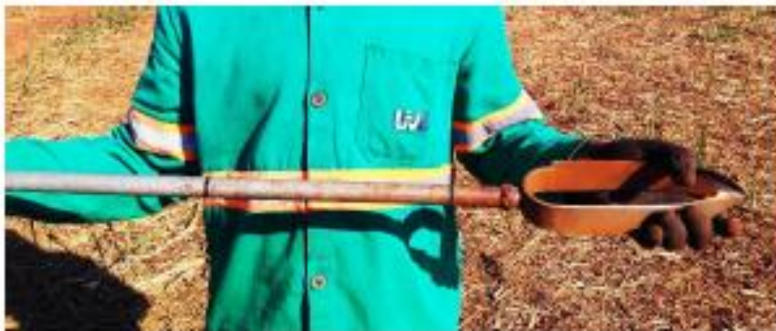
Figura 6. Ferramenta de coleta de solo – trado holandês.
