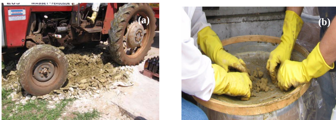
Figura 3: Procedimento utilizado para o esmagamento do lodo físico-químico (a) quebra do material com o rodado do trator e (b) peneiramento do resíduo.
