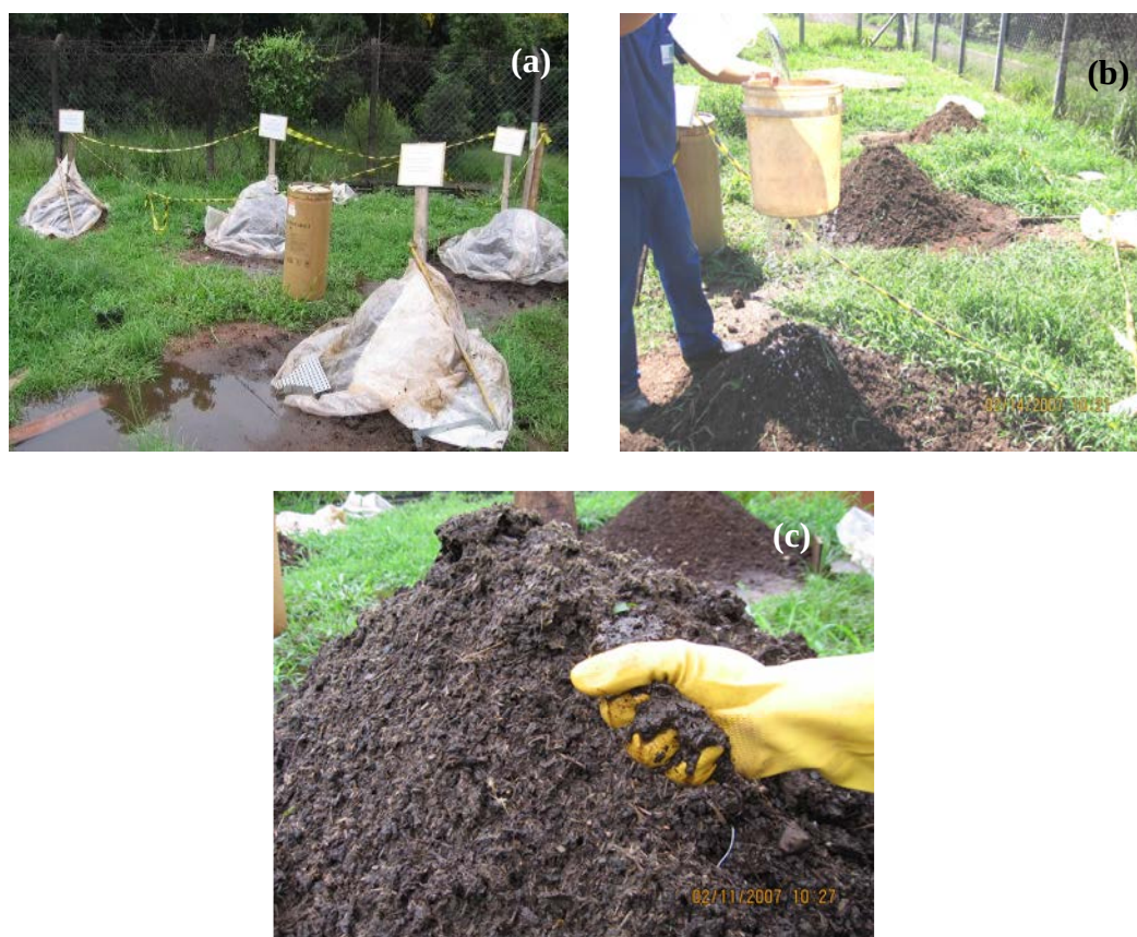
Figura 6. Determinação e monitoramento da umidade do material (a) cobertura das pilhas com lona plástica, (b) umedecimento das pilhas secas e (c) verificação de umidade – “teste da esponja”.
