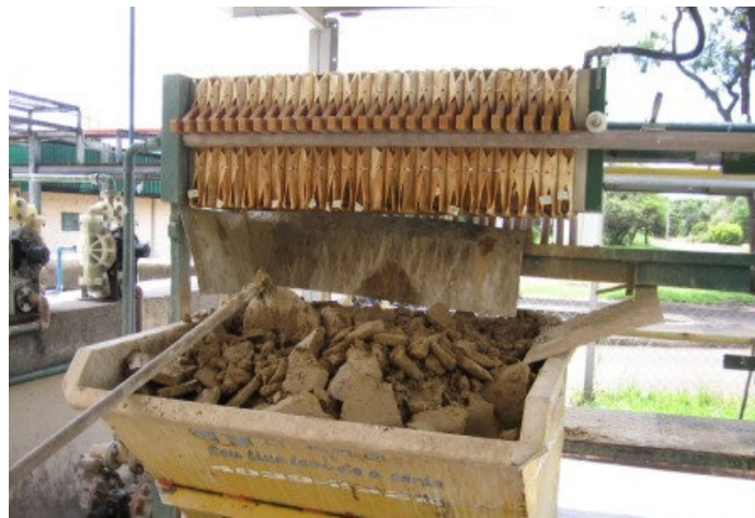
Figura19. Equipamento utilizado no processo de filtragem e prensagem do lodo.
