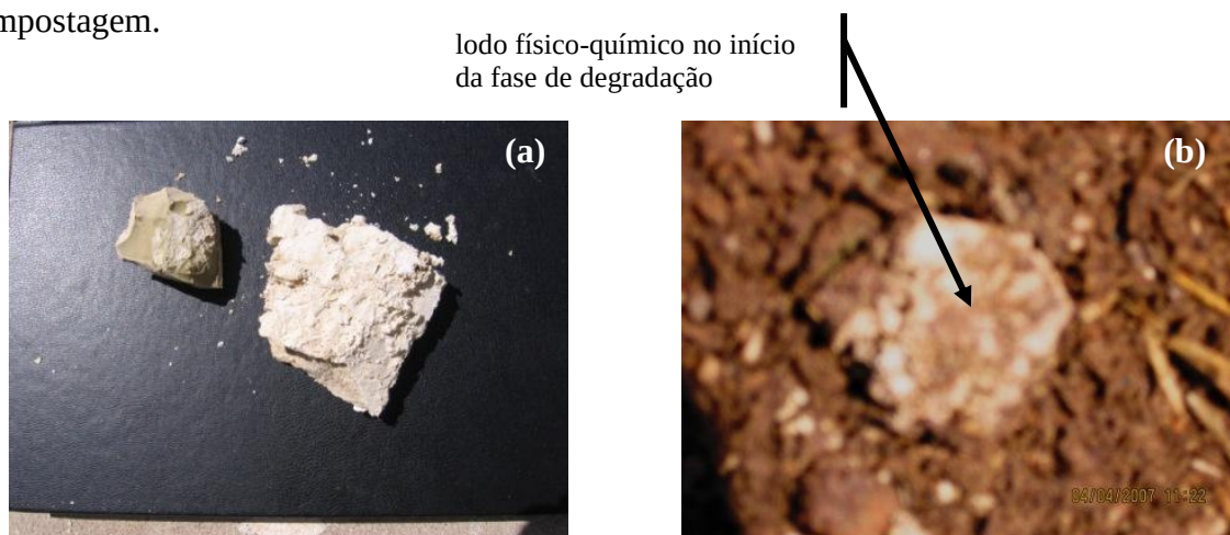
Figura 11. Fases do estado do lodo físico-químico (a) material antes do processo de compostagem, ainda empedrado, (b) Início da fase de degradação, durante a compostagem.
