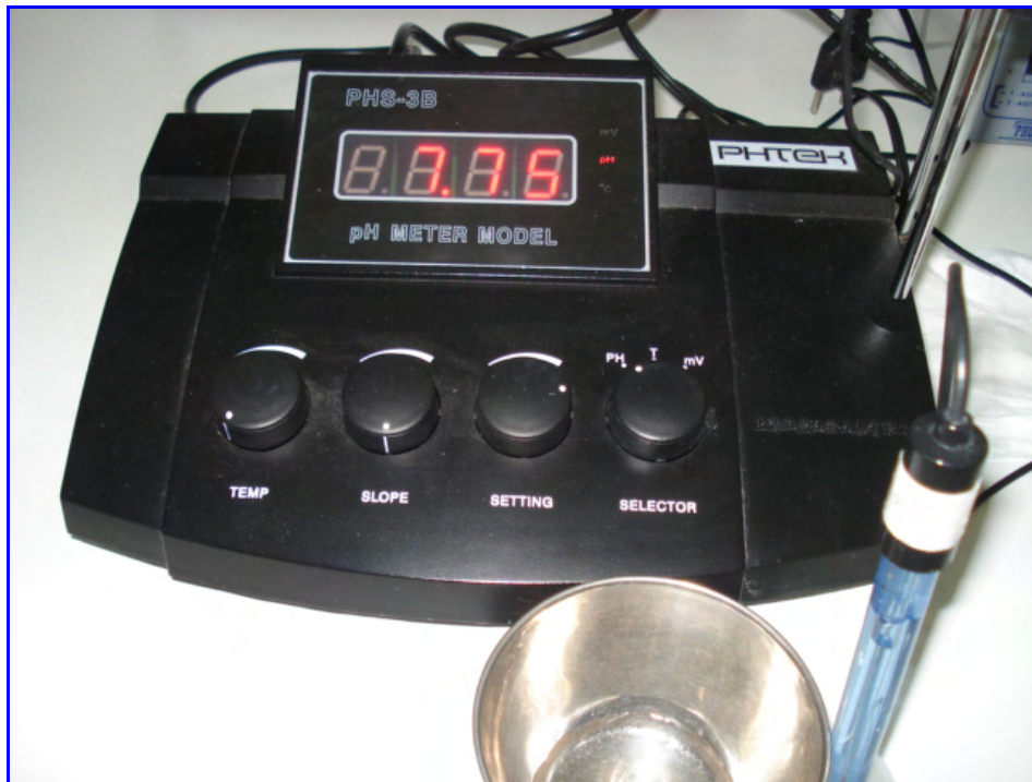
Figura 13. Aparelho utilizado para medir o pH e capacidade tampão da saliva.
