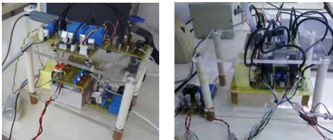
Figura 65: Protótipos do inversor Buck-Boost : Baseado em RB-IGBTs (esquerda) e baseado em associação série diodo-MOSFET (direita).
