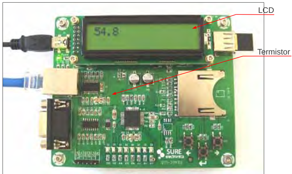
Figura 78: Termistor e LCD da placa microcontrolada.
