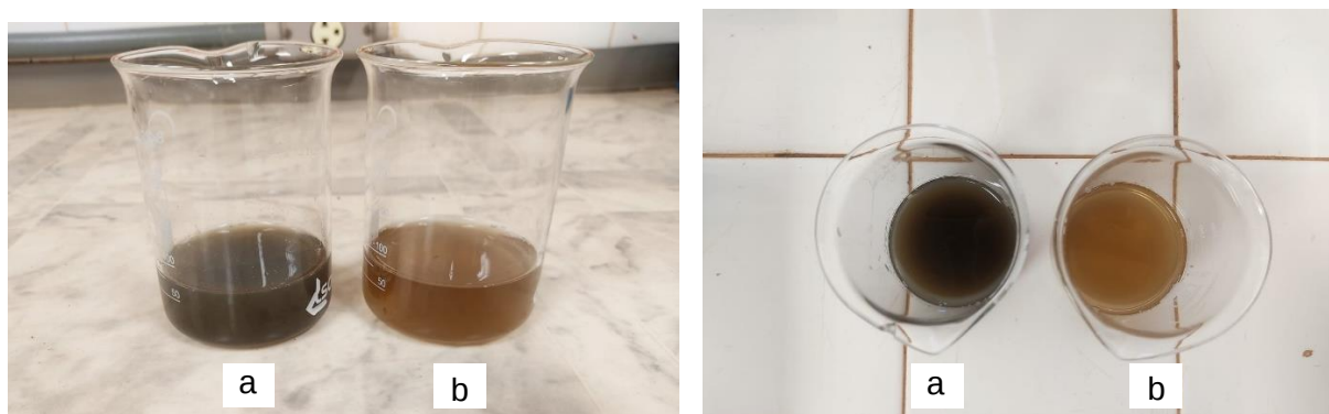
Figura 32 - Biofertilizante gerado pelo biodigestor (a) versus biofertilizante gerado pelo sistema de filtragem anaeróbio vertical (b)
