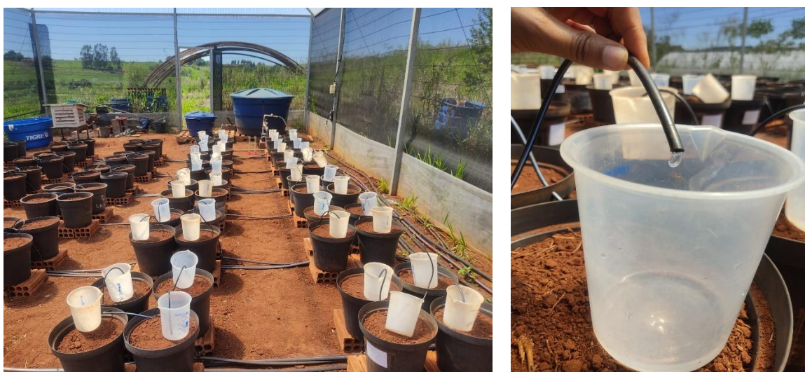
Figura 24 - Imagens do teste de uniformidade de aplicação de água realizado no início do experimento, antes do plantio da cultura
