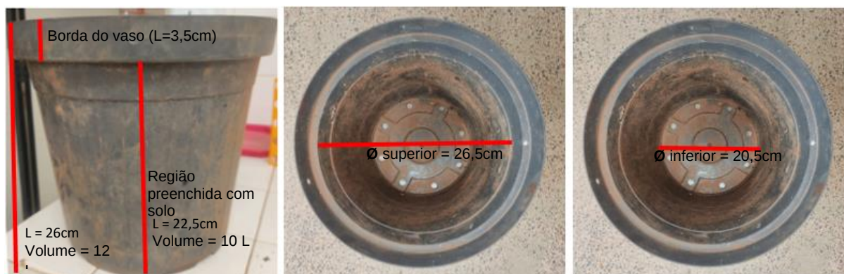
Figura 18 - Descrição das características do vaso utilizado
