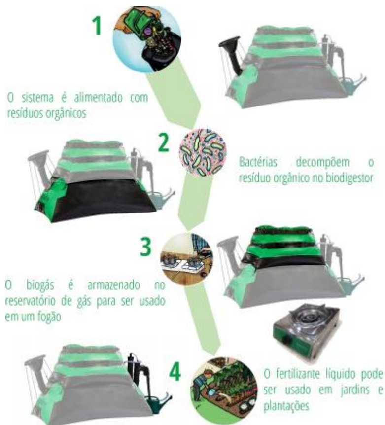
Figura 5 - Demonstração do funcionamento do sistema HomeBiogas™ 2.0
