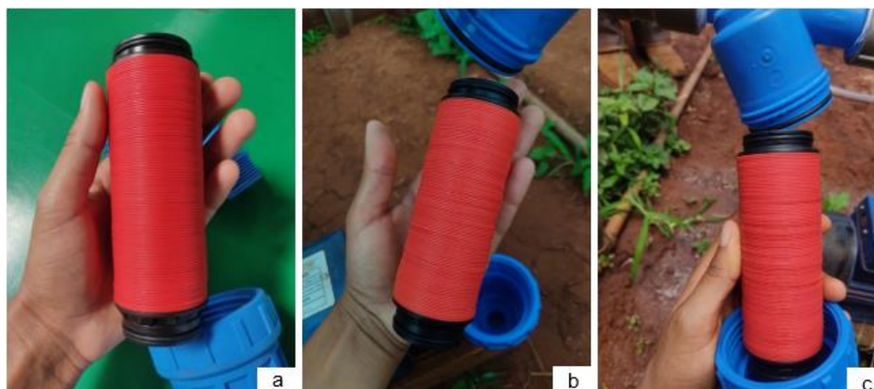
Figura 36 - Imagens do estado interno do filtro de disco utilizado no sistema de irrigação no início meio e fim do experimento
